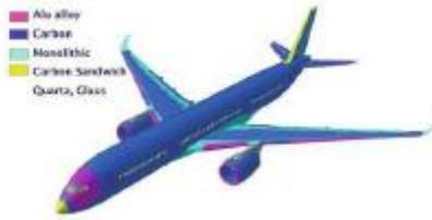
Figura 2.6: A350 (futuro próximo). Se prevé estará formado por un 55% en peso de materiales compuestos.
