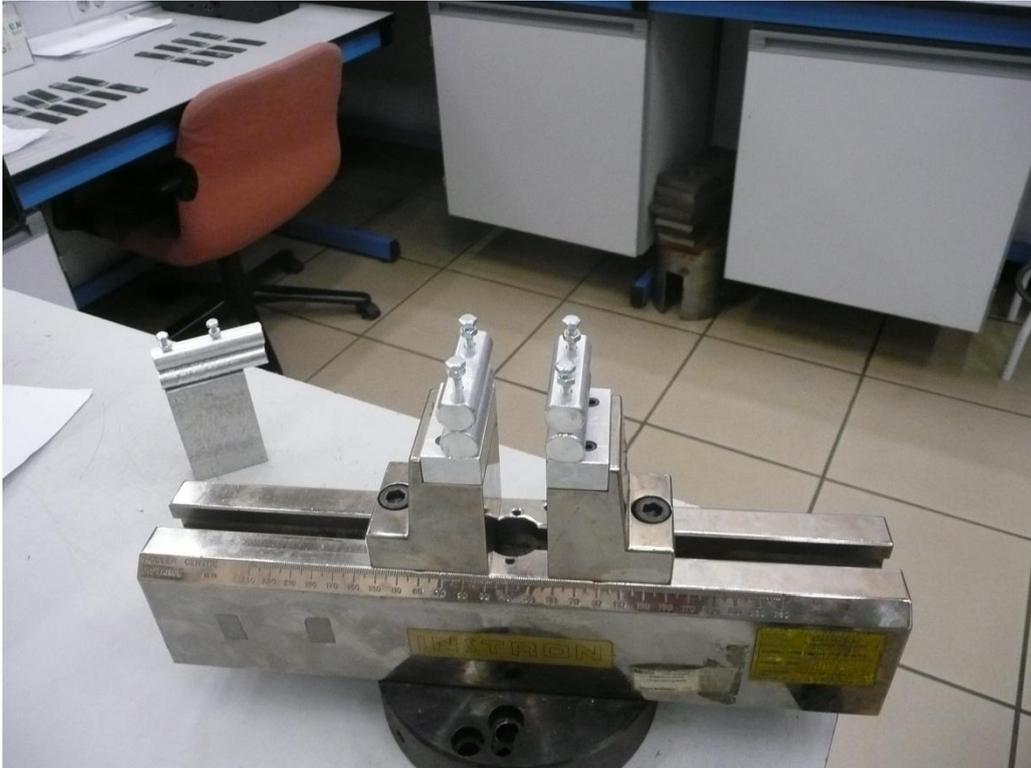
Figura 3.3: Aspecto que mostraba el útil de flexión para los ensayos de tracción-compresión que se fabricó en un principio.
