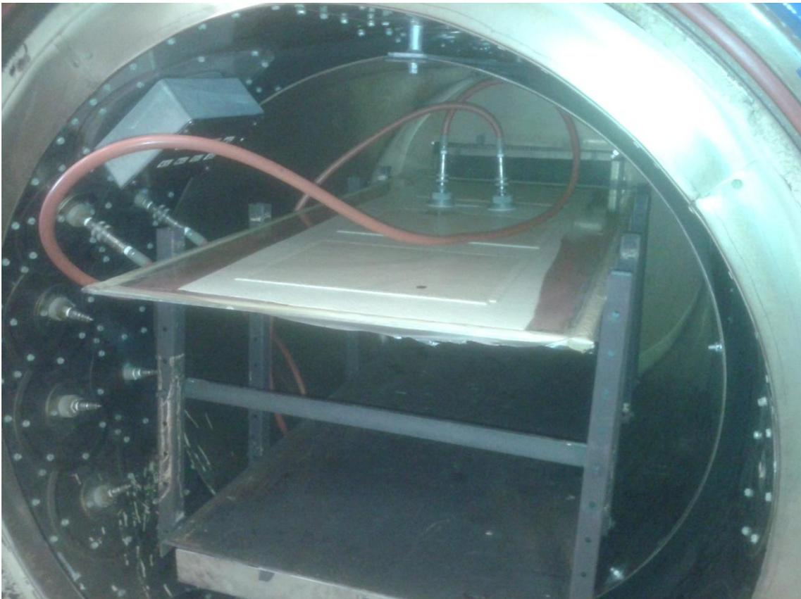
Figura 4.6: Imagen del autoclave con la bolsa de vacío con los paneles en su interior.
