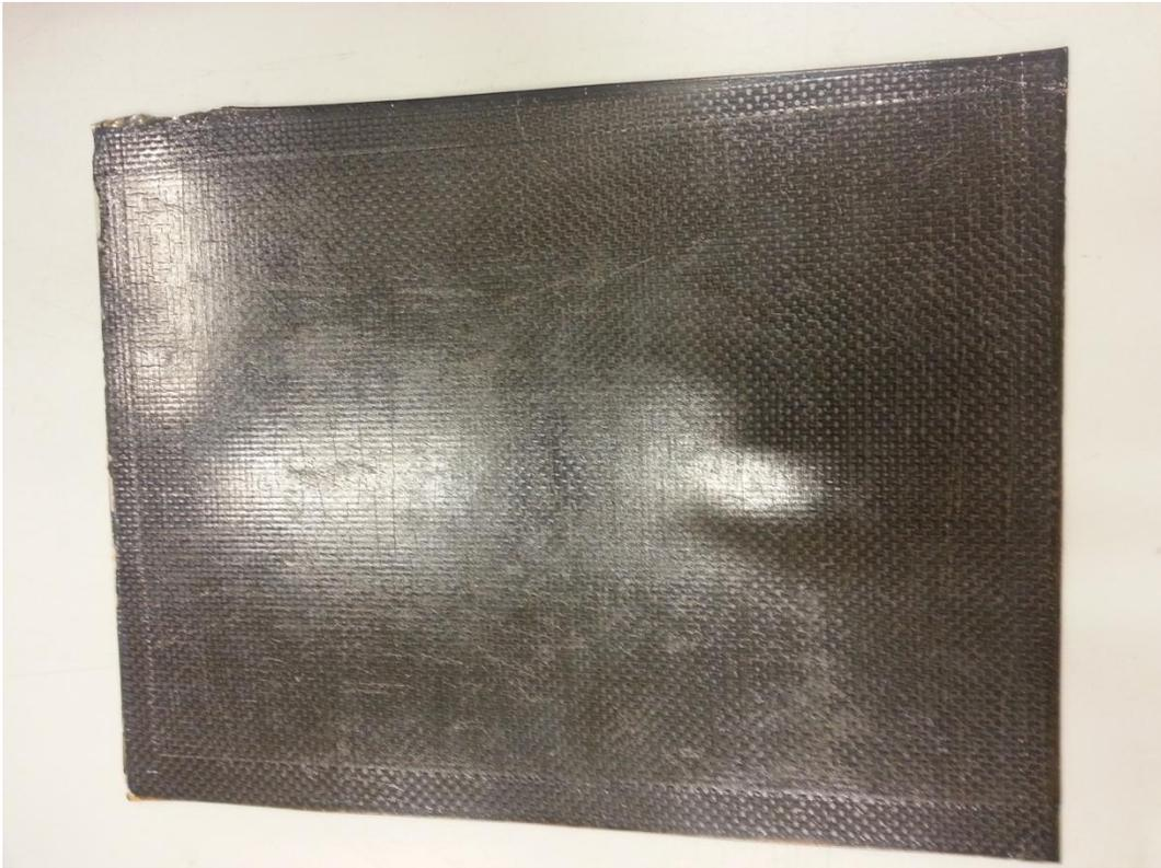
Figura 4.8: Aspecto que ofrecía el segundo panel al ser sacado de la prensa tras el proceso de curado.
