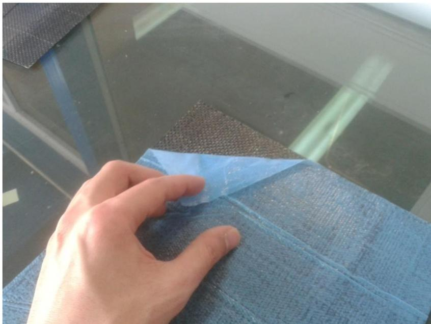
Figura 4.2: Eliminación de la capa protectora adhesiva durante el proceso de apilado.
