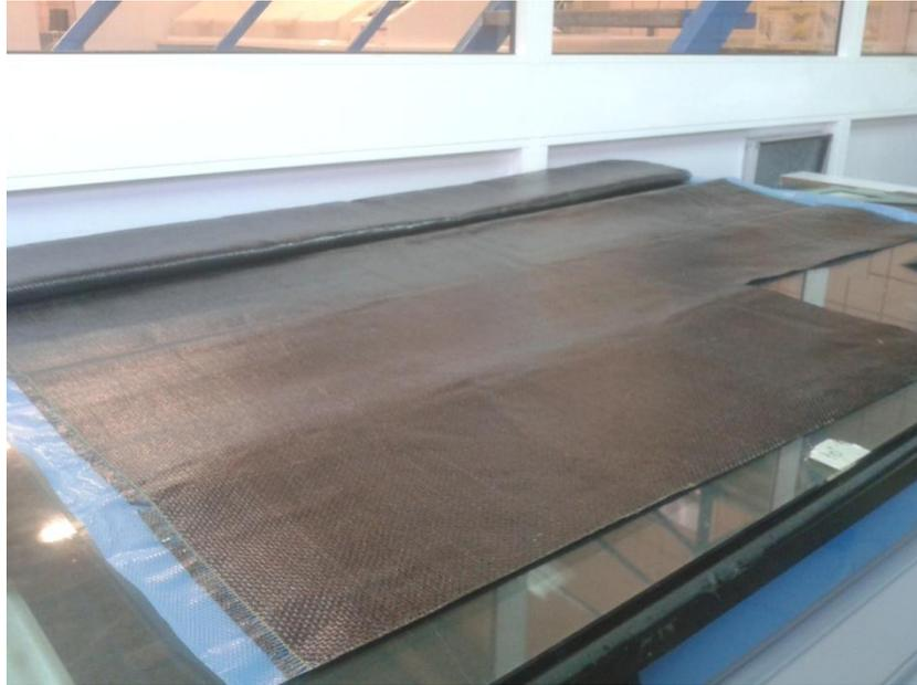
Figura 4.1: Muestra del prepreg sobre el que se realizó el corte de las capas del laminado.
