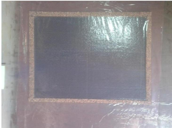
Figura 4.4: Laminado sellado con corcho y con otra fina capa de teflón dispuesta encima.
