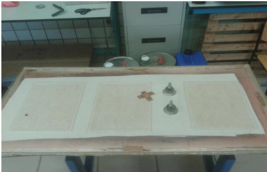
Figura 4.5: Bolsa de vacío ya lista para ser introducida en el autoclave.
