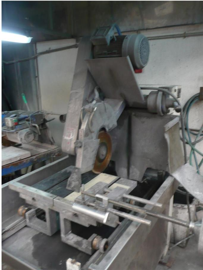
Figura 4.9: Máquina empleada en el corte de las probetas.
