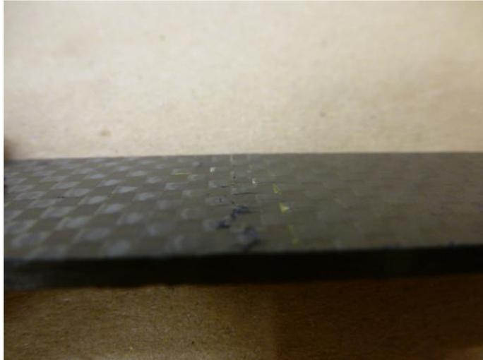
Figura 5.19: Detalle de las irregularidades consecuencia de la rotura de las capas más superficiales.
