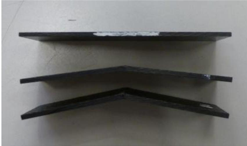
Figura 5.30: Probetas que rompieron a fatiga en el ensayo de flexión en 3 puntos vistas de perfil.
