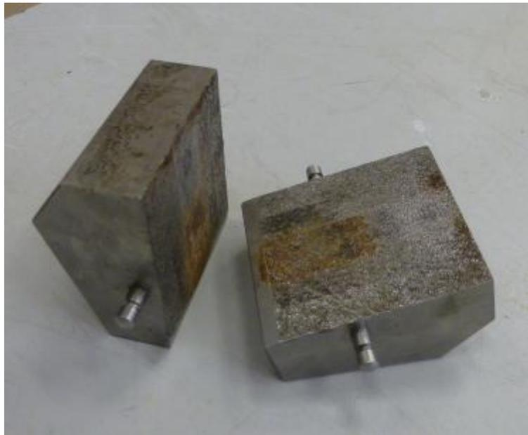
Figura 5.4: Mordazas planas de la máquina de ensayos dinámicos.
