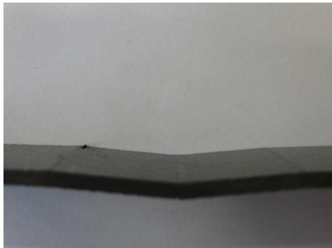
Figura 5.10: Aspecto que ofrecía la primera de las probetas ensayadas para el caso estático empotrado. Se aprecia la fractura en la zona central pero también las fisuras en los lados.
