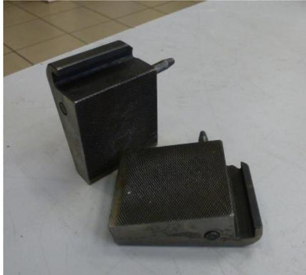
Figura 5.2: Mordazas utilizadas en la máquina de ensayos estáticos.
