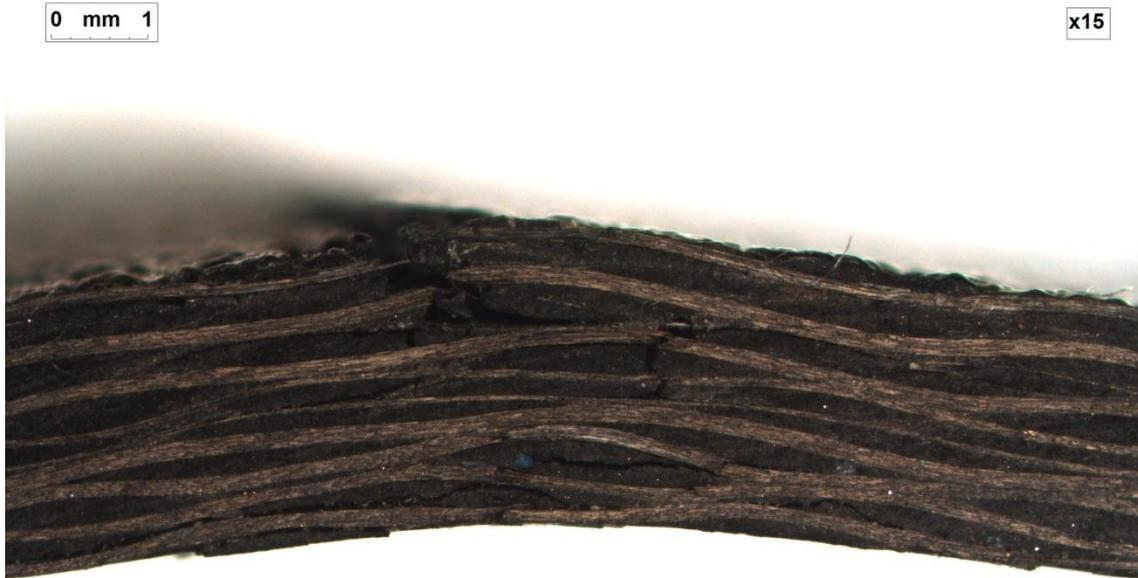
Figura 5.29: Micrografía de la zona central de la probeta nº 11 perteneciente al ensayo de flexión en tres puntos. Aumento x15.
