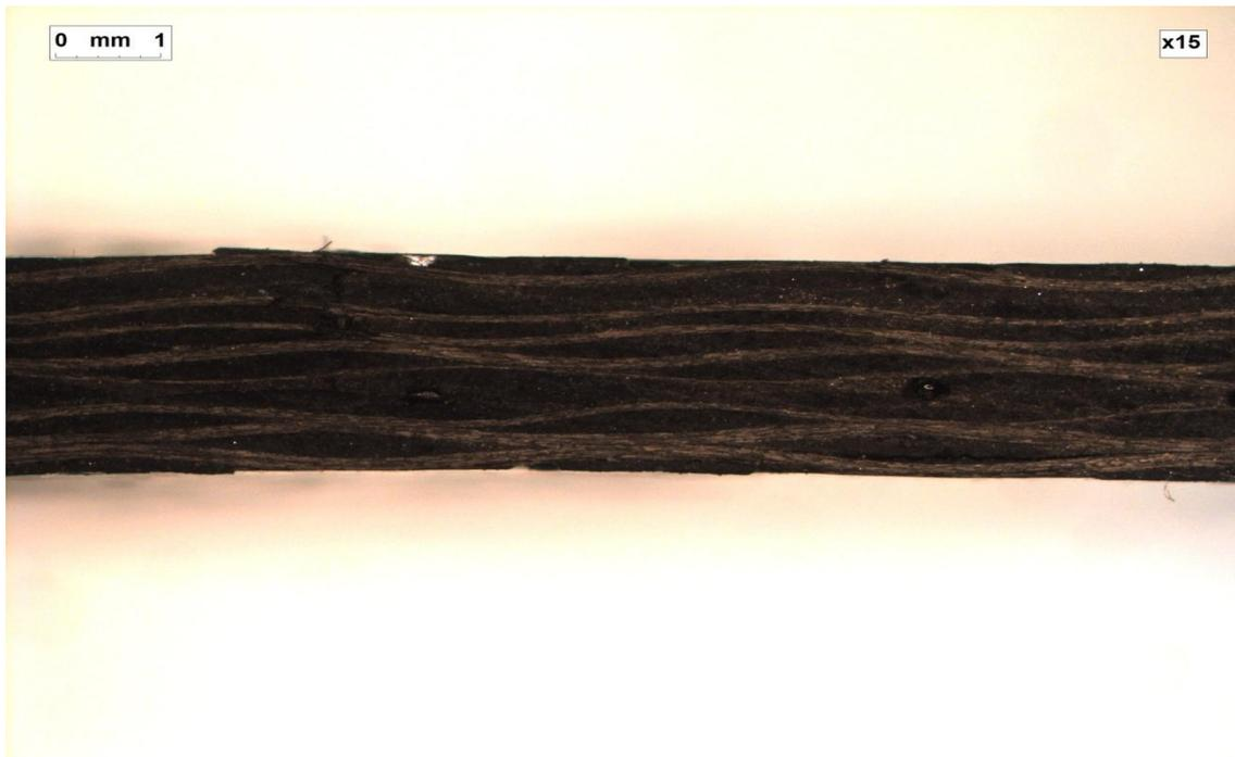
Figura 5.28: Micrografía de la probeta nº 5 (70% de carga) de extremos articulados con aumento x15.
