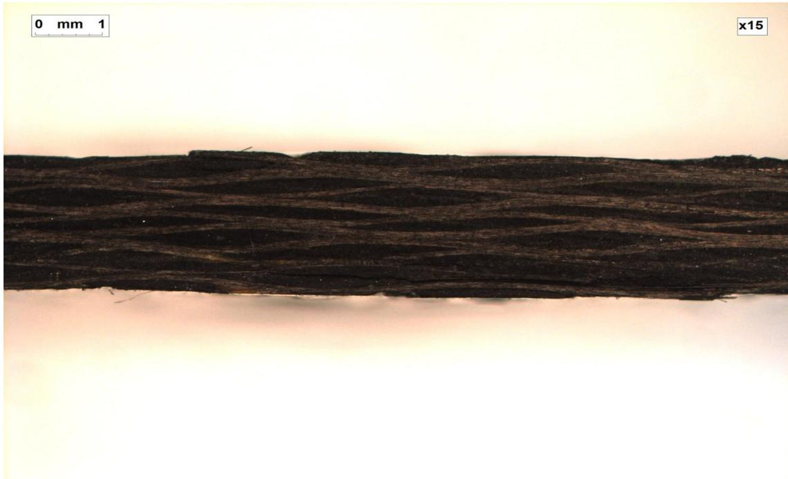
Figura 5.25: Micrografía de la probeta nº 12 (55% de carga) de extremos articulados con aumento x15.
