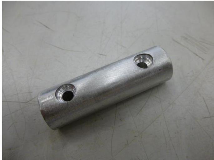
Figura 5.7: Aspecto que ofrecían los apoyos después del empleo del torno para crear esas hendiduras donde se alojarían las cabezas de los tornillos.
