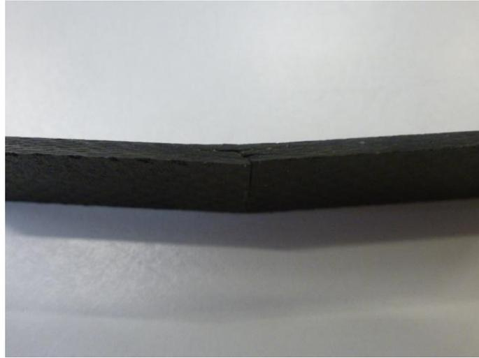
Figura 5.15: Así quedó la primera probeta como resultado del ensayo estático articulado.
