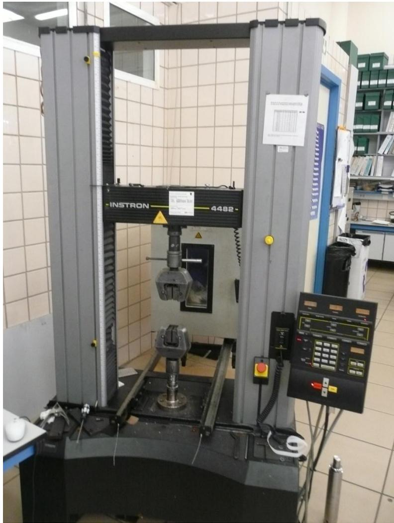
Figura 5.1: Máquina INSTRON de ensayos estáticos.
