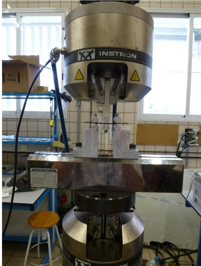
Figura 5.6: Ejecución de un ensayo de fatiga con extremos articulados.
