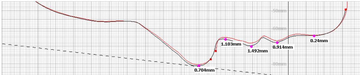
Figura 4.4: Medidas de la diferencia de desplazamientos en los cinco puntos que serán la referencia para el ajuste
