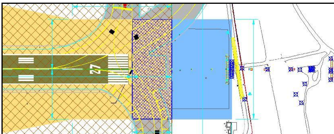
Situación de obstáculos dentro de RESA 09 240x120m pero fuera de la RESA 09 declarada (puntos azules)
