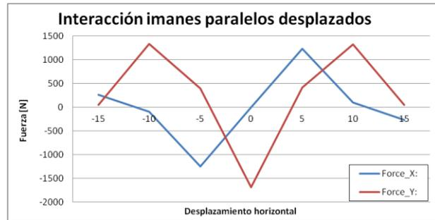
Figura 141. Interacciones entre imanes enfrentados, desplazados paralelamente, parcialmente apantallados
