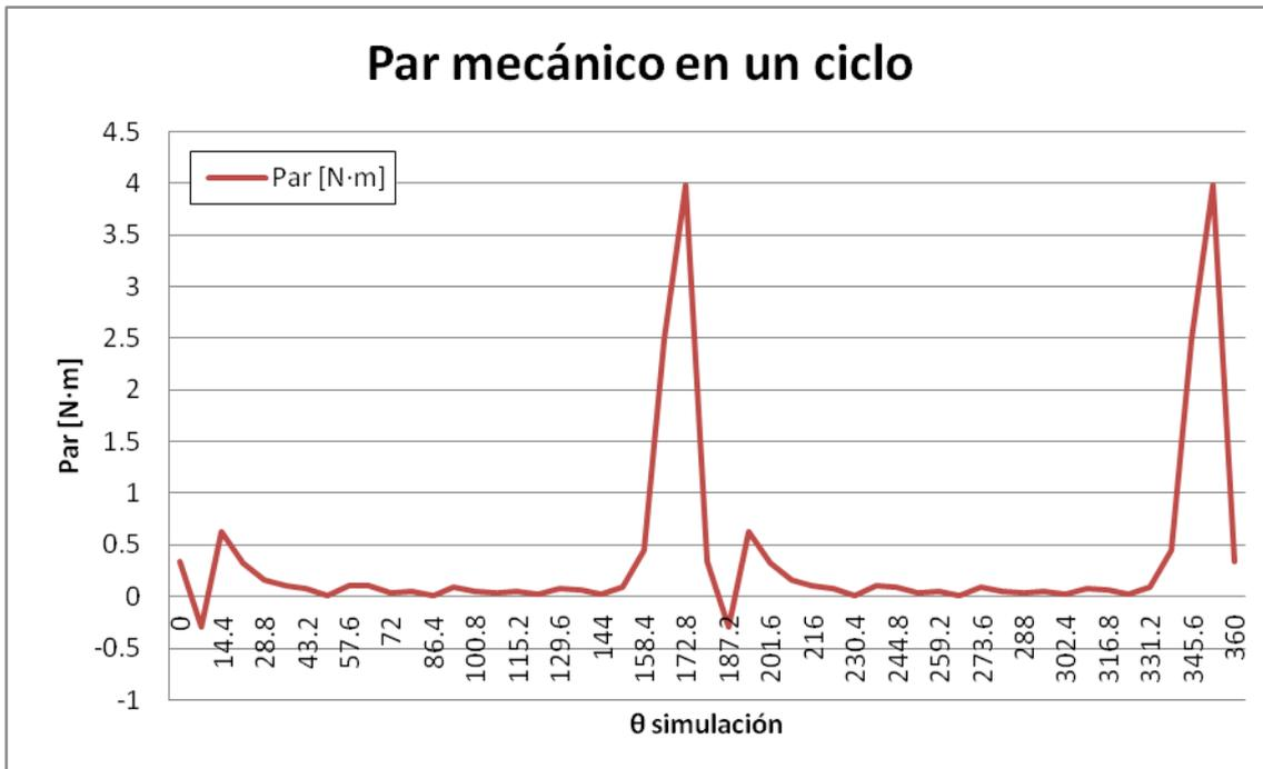
Figura 147. Par mecánico para dos pares de imanes en un ciclo completo
