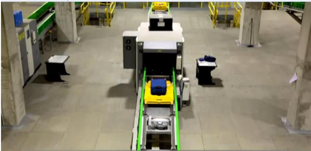
Tras realizar el análisis, el resultado es recibido en el centro de control, que asigna automáticamente el estado de clarificado o no clarificado al equipaje. Los dos caminos vuelven a confluir en uno, y previo a la bifurcación en vertical se realiza una nueva lectura RFID. En el centro de control se recibe la identidad de la maleta y si ésta ha sido aprobada, caso en el que
