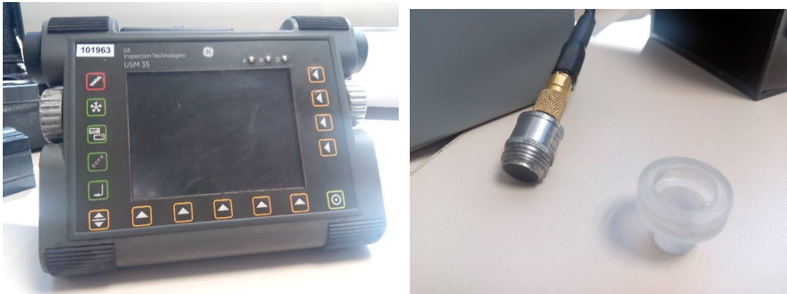
Imagen 31: Equipo de inspección manual y palpador utilizados
