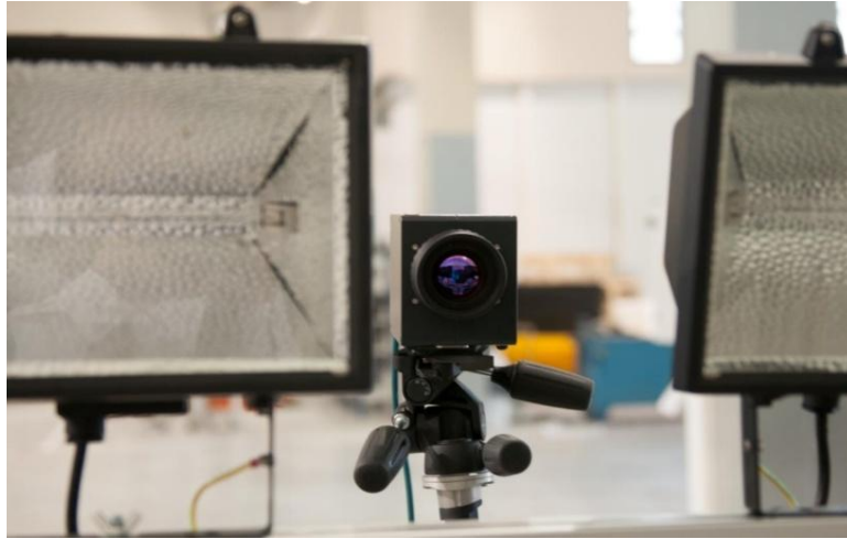
Imagen 46: Cámara de termografía
