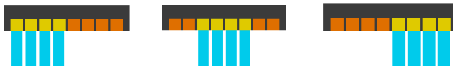
Imagen 35: Secuencia de leyes focales para barrido lineal [14]
