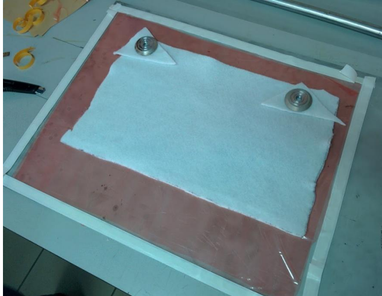
Imagen 21: Tejido aireador, tomas de vacío y sellante
