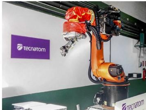
Imagen 1: Sistema robotizado de inspección (TECNATOM) [3]
