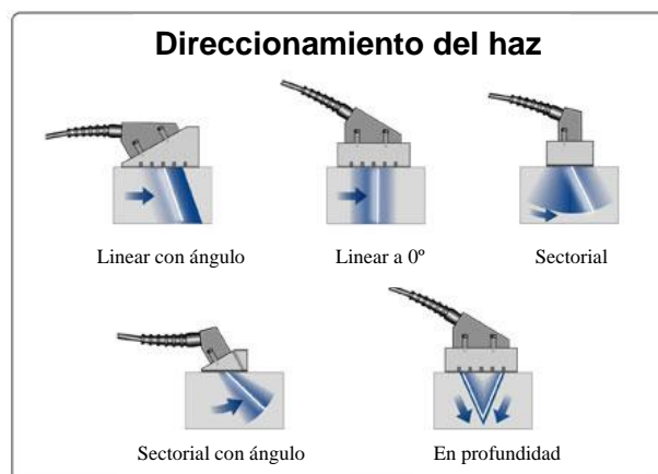
Imagen 33: Aplicación phased array: barridos electrónicos [14]
