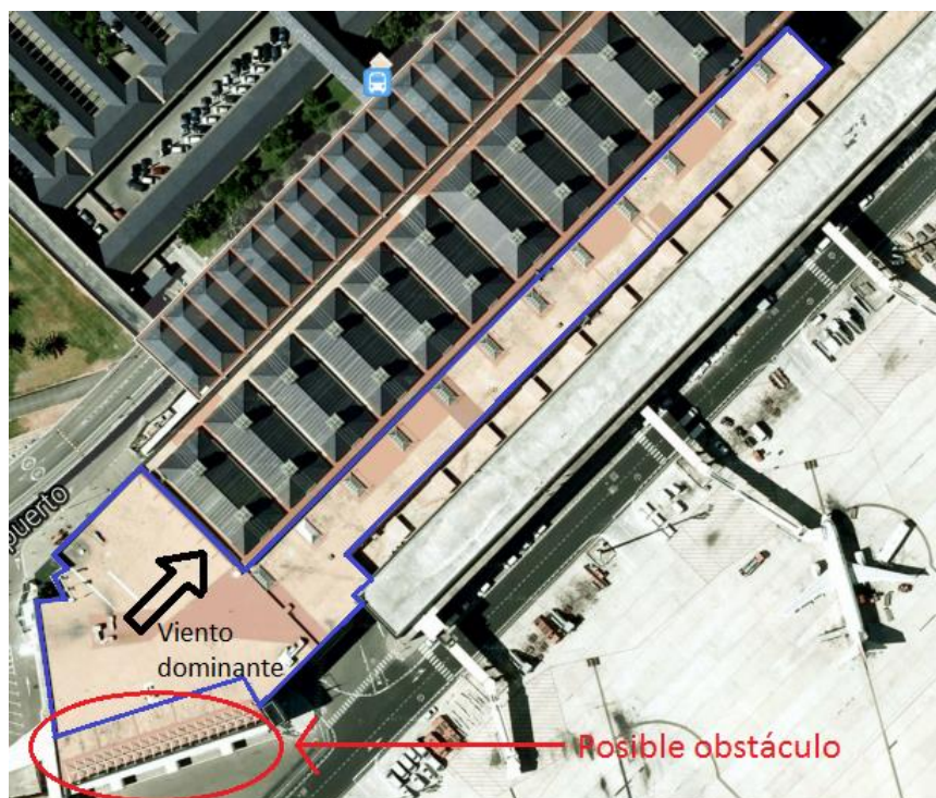
Imagen 50.- Emplazamiento propuesto para la instalación eólica e identificación de obstáculos.
