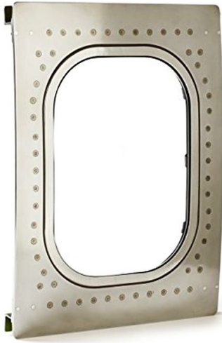
Figura 3.24: Remachado ventana fuselaje
