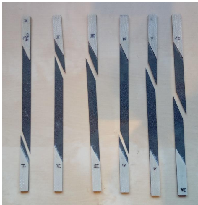
Figura 54 - Seis probetas de 20 grados ensayadas a tracción.
