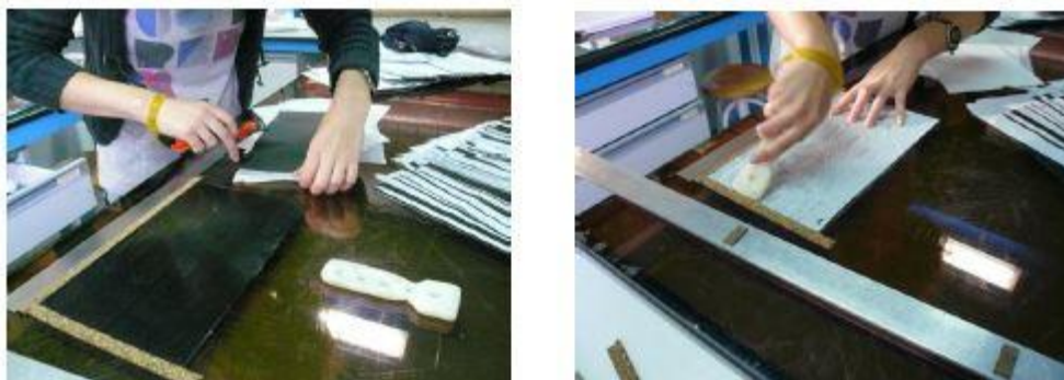
Figura 24 - Proceso de compactado de las láminas en la Sala Limpia
