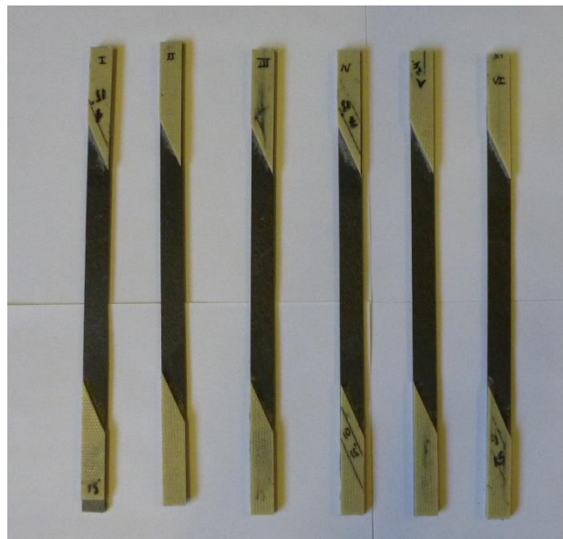
Figura 47 - Probetas orientadas 15 grados con tacos de 24 grados pegados.
