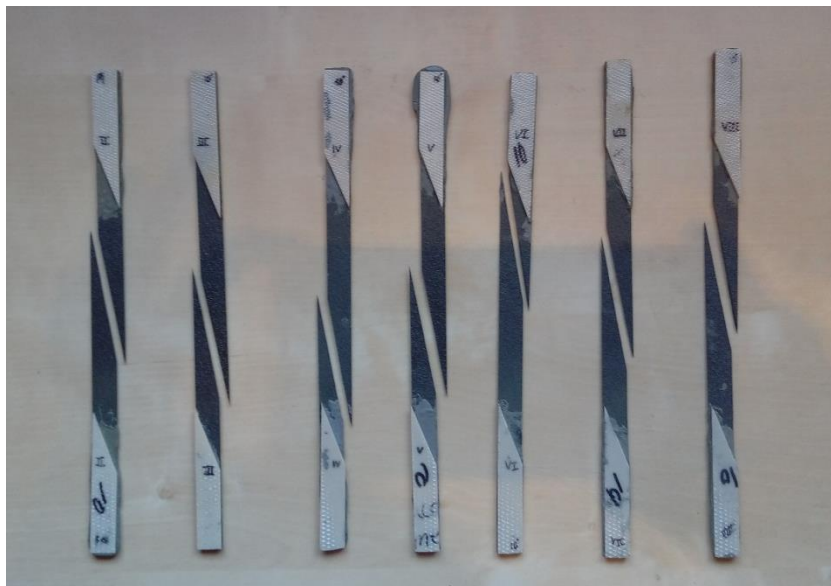
Figura 52 - Siete probetas de 10 grados ensayadas a tracción.
