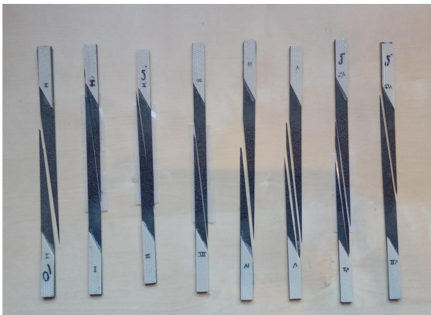
Figura 51 - Ocho probetas de 5 grados ensayadas a tracción.
