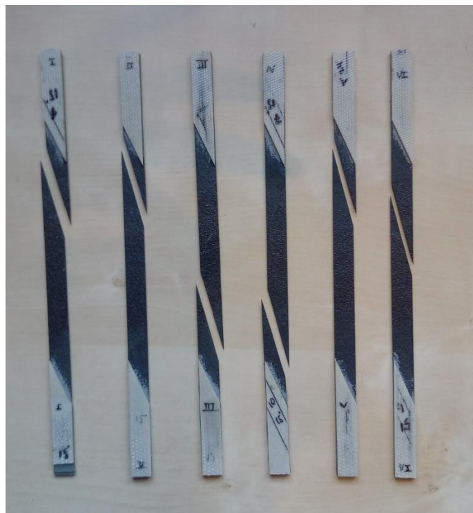
Figura 53 - Seis probetas de 15 grados ensayadas a tracción.
