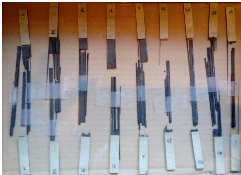
Figura 50 - Nueve probetas de 0 grados ensayadas a tracción.
