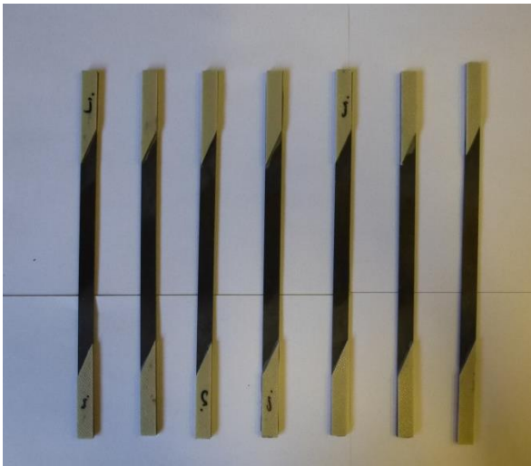
Figura 45 - Probetas orientadas 5 grados con tacos de 28 grados pegados.
