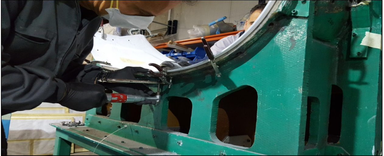
Útil de taladrado de la pieza.
