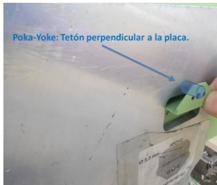
Poka-Yoke: Tetón perpendicular a la placa.
