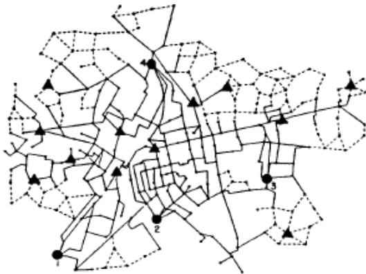
Fig. 24. ● Subestaciones existentes, ▲ Nudos candidatos para nuevas subestaciones.
