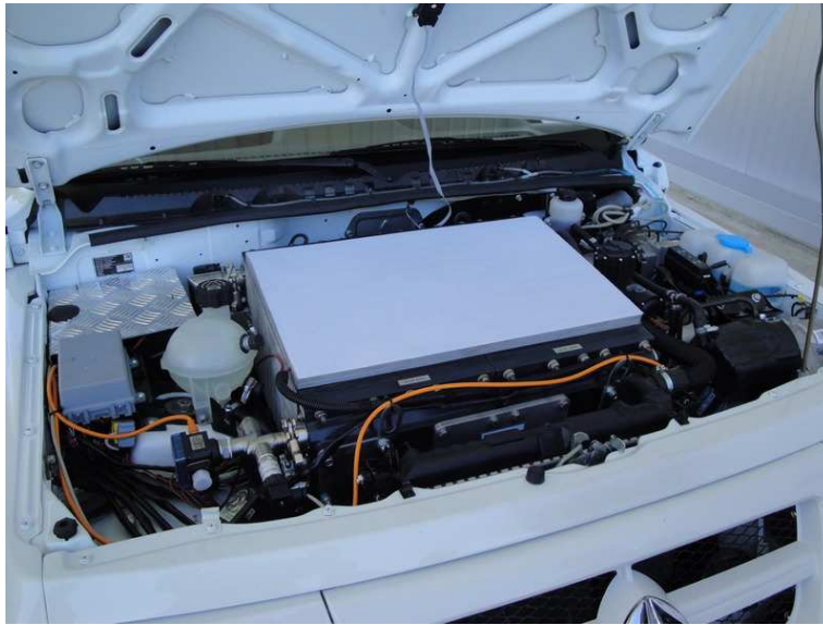
Figure 3.8: Pila de combustible integrada en el vehículo.
