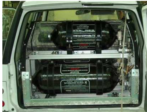
Figure 3.2: Integración de los depósitos de hidrógeno en el vehículo.
