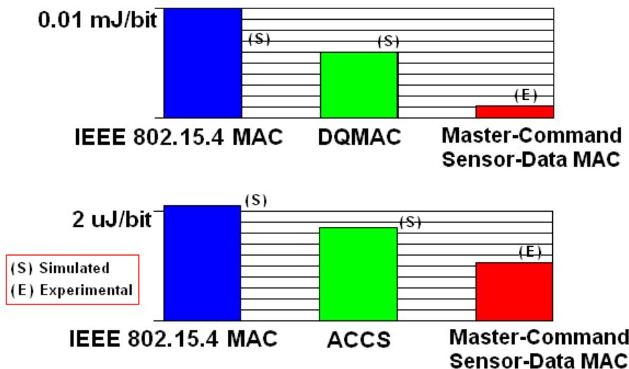
Fig. 17. Comparación del consumo de energía con diferentes protocolos MAC.
