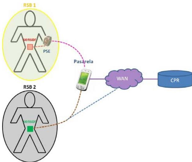
**Figura 1.** Diagrama de bloques de los dos Escenarios: Distribuido (RSB1) y Concentrado (RSB2).
