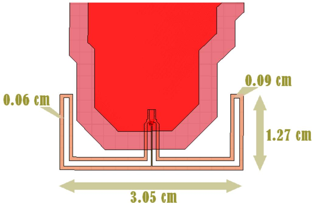
Fig. 9. Dimensiones de la antena microstrip diseñada.
