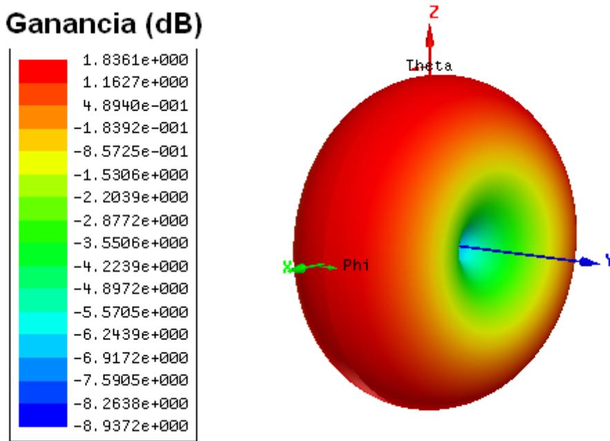
Fig. 11. Diagrama de radiación.
