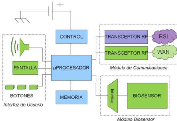
**Figura 2.** Arquitectura hardware del Sensor Inteligente (los módulos de color verde no aparecen en ambos escenarios).
