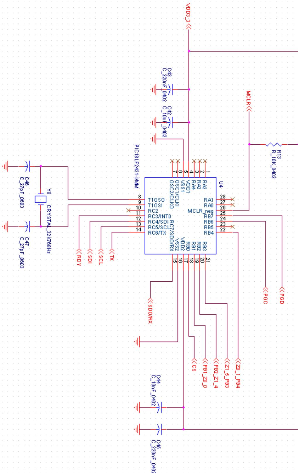
Fig. 8. Esquemático del Microcontrolador PIC18LF2431 de Microchip y componentes asociados en el SOM.
