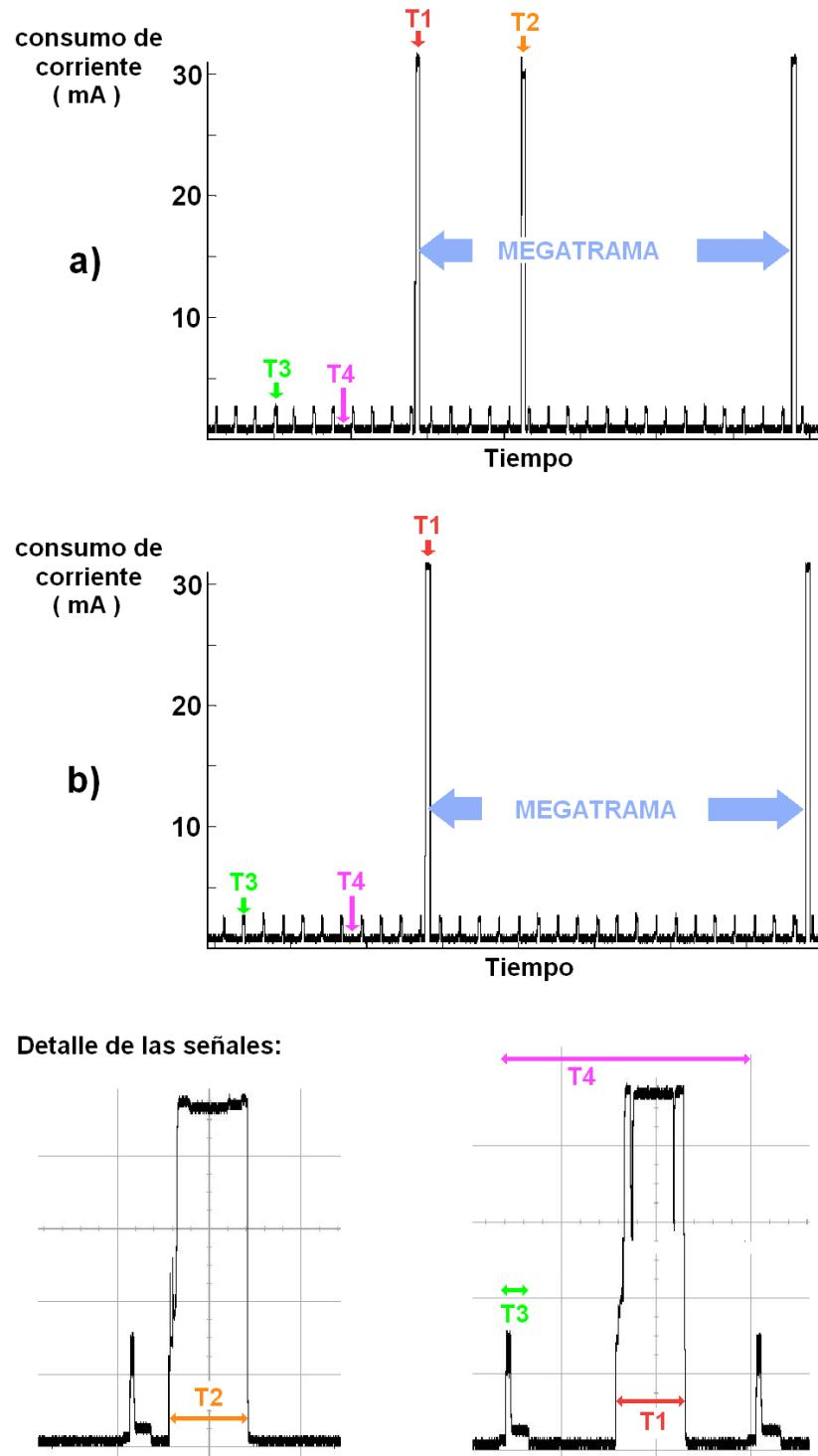
Fig. 12. Consumo experimental de corriente en tiempo real (a) sólo cuando se detecta un impacto (b) con el protocolo MAC MCSD.
