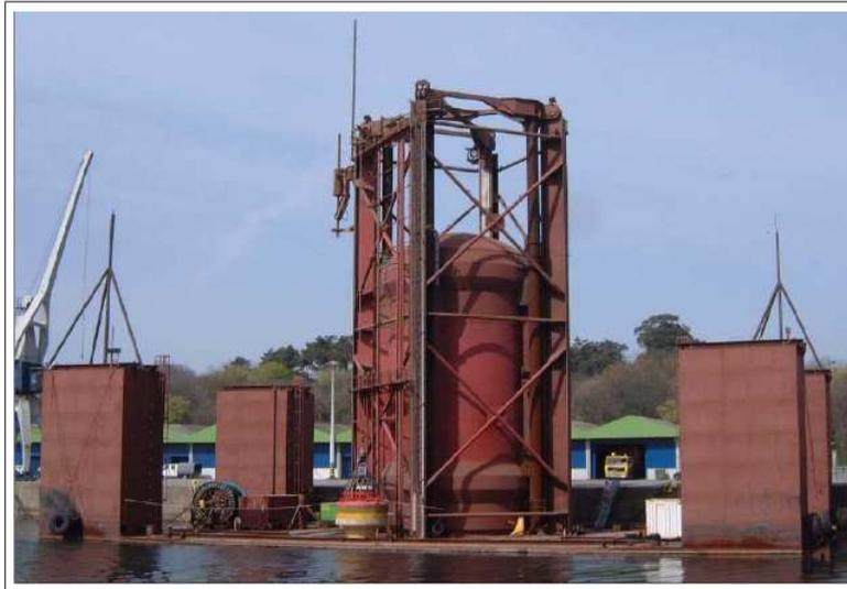
Fig. 1.15: El oscilador de la ola de Arquímedes antes de ser sumergido en las aguas de Portugal
