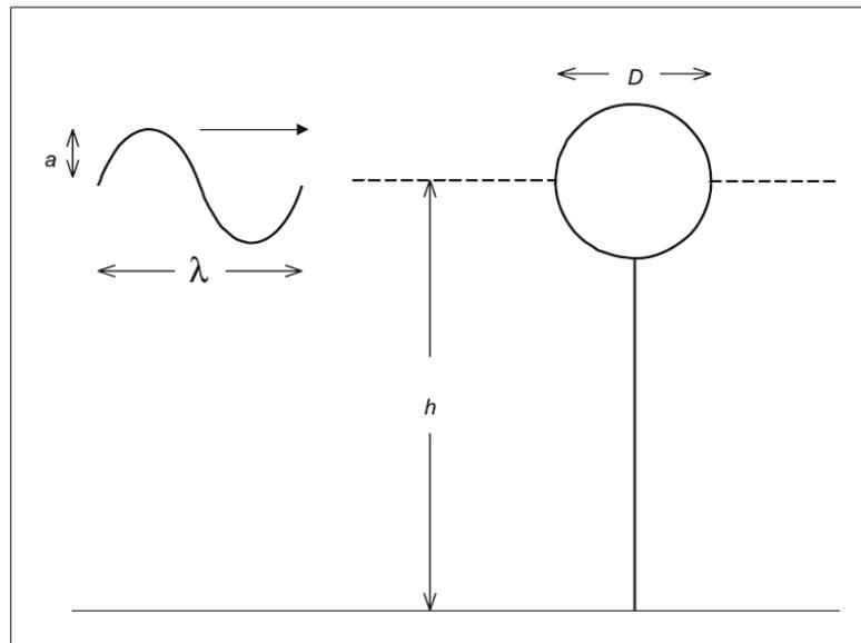
Fig. 3.2: Esquemático de un dispositivo WEC *heave* esférico (Cruz 2008)
