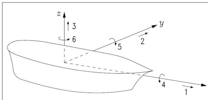
Fig. 3.1: Modos de movimiento de un cuerpo rígido en un fluido (Falnes 2004)
