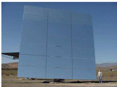
*Imagen 15: helióstato de vidrio-metal de 90 m<sup>2</sup> de superficie-reflexiva*
