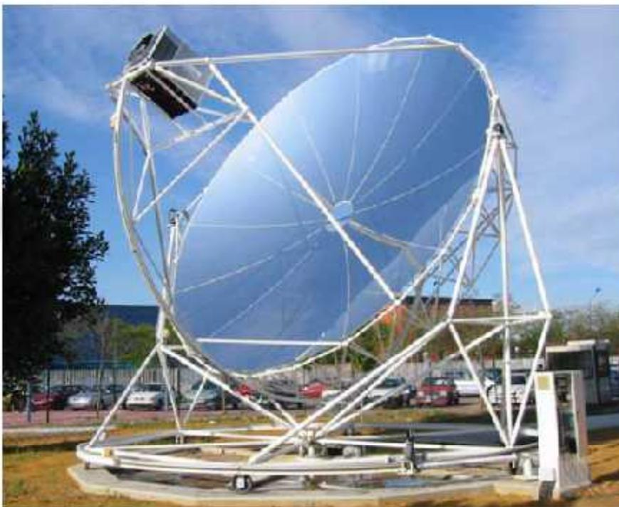
*Imagen 18: planta Disco Parabólico 10 KWe Escuela de Ingenieros Industriales de Sevilla*
