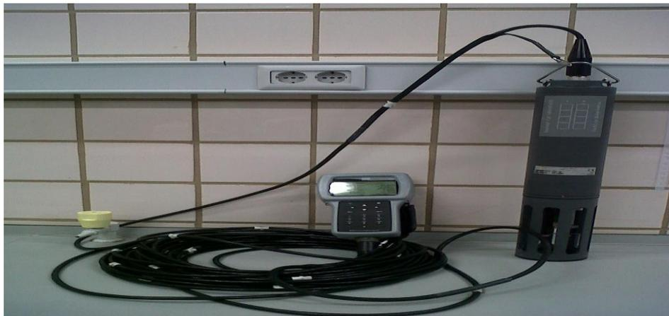
Figura 20. Sonda Multiparamétrica YSI 6-Serie
