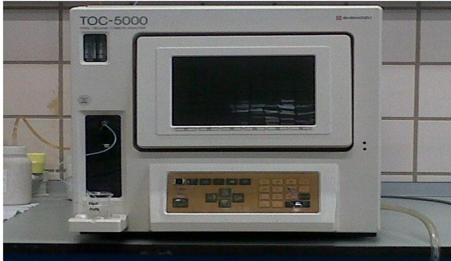
Figura 22. Analizador de carbono orgánico total (Shimadzu Corporation TOC-5000)
