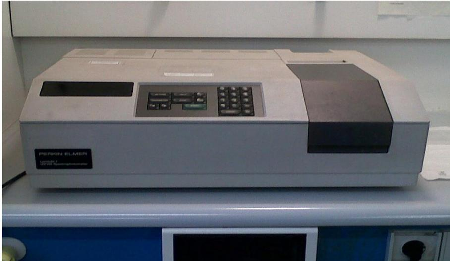
Figura 23. Espectrofotómetro UV-Visible (PERKIN-ELMER. Lambda 2)
