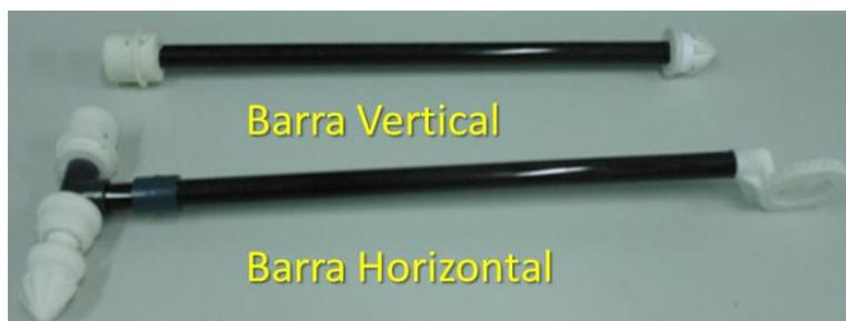
Fig. 28. Barras verticales y horizontales usadas como cargas del manipulador definitivo
