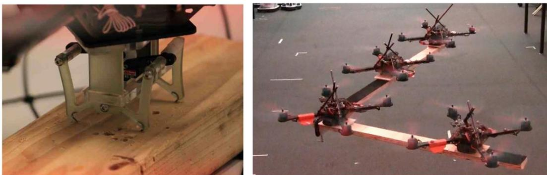
Fig. 16. Pinza con microespinas (izq.) y 4 quadrotors transportando una carga con este mecanismo de agarre (der.)
