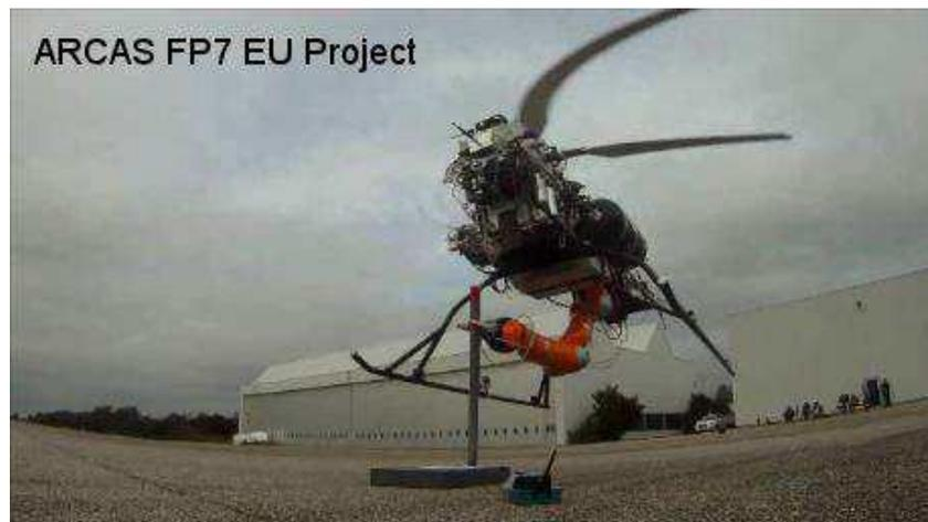
Fig. 10. Experimento para atrapar una barra en tierra con un helicóptero autónomo y el manipulador LWR, usando control por visión
