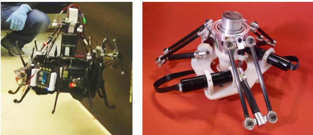
Fig. 18. UAV *Ducted-fan* en contacto estable con una superficie vertical (izq.) usando para ello un manipulador tipo delta con cinemática paralela (der.)
