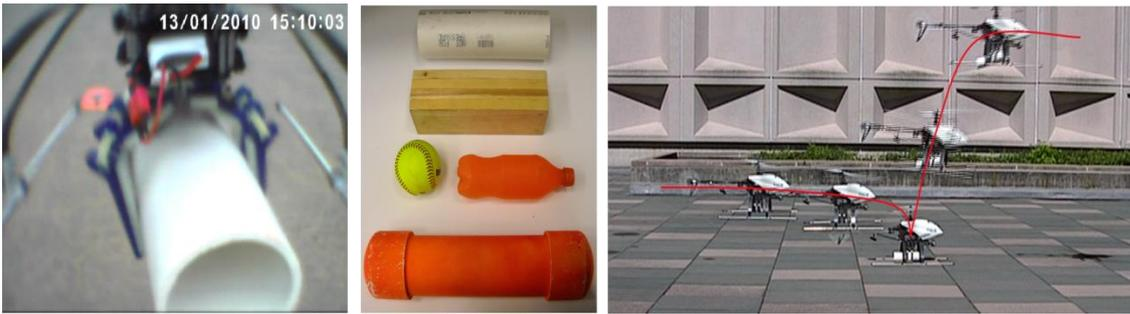
Fig. 3. Imagen tomada desde una cámara a bordo para medir la precisión en el aterrizaje (izq.), diversos objetos para comprobar la capacidad de adaptación de la pinza en el agarre (cen.) y trayectoria de vuelo del helicóptero para la captura de la carga (der.)
