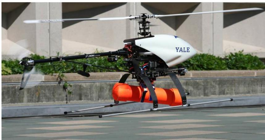
Fig. 1. Manipulador Aéreo haciendo hovering con una carga de peso de 900g
