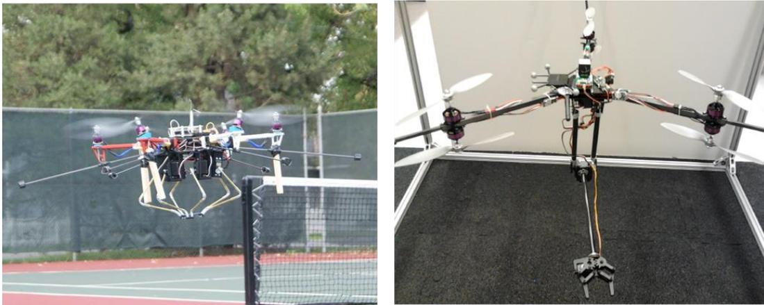
Fig. 17. Manipulador de cinemática paralela de 6 GDL (izq.) y brazo de 3 GDL con elevada longitud y pero respecto a la plataforma aérea sobre el que se instala (der.)
