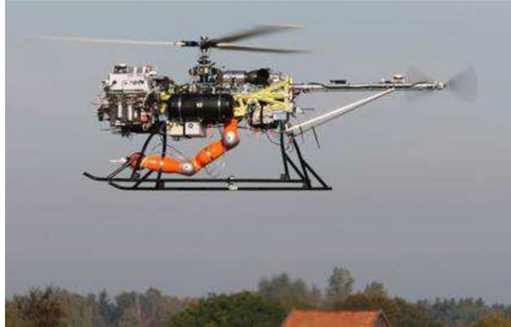
Fig. 9. Helicópteros autónomos con el brazo LWR III KUKA-DLR
