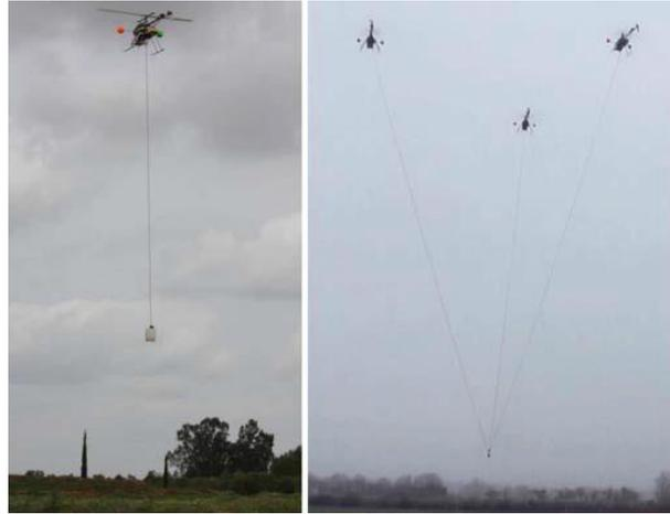
Fig. 6. Transporte de carga suspendida mediante cuerdas con un solo UAV (izq.) y con múltiples (der.)
