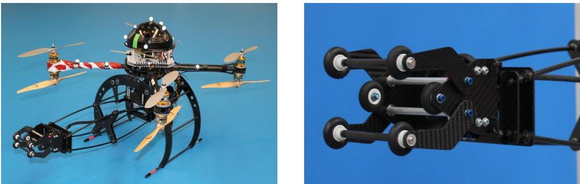
Fig. 25. Prototipo 2 del Manipulador. Para los experimentos se emplea un octocóptero ADX
