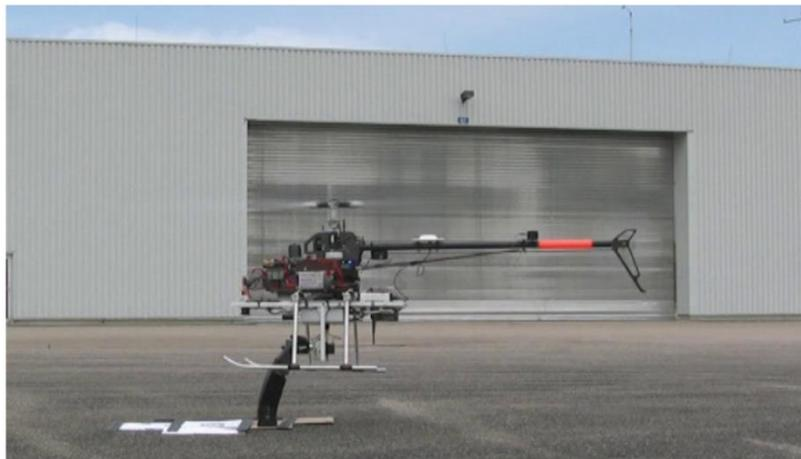
Fig. 8. Experimento *outdoor* para atrapar desde un helicóptero autónomo objetos que se encuentran en el suelo.
