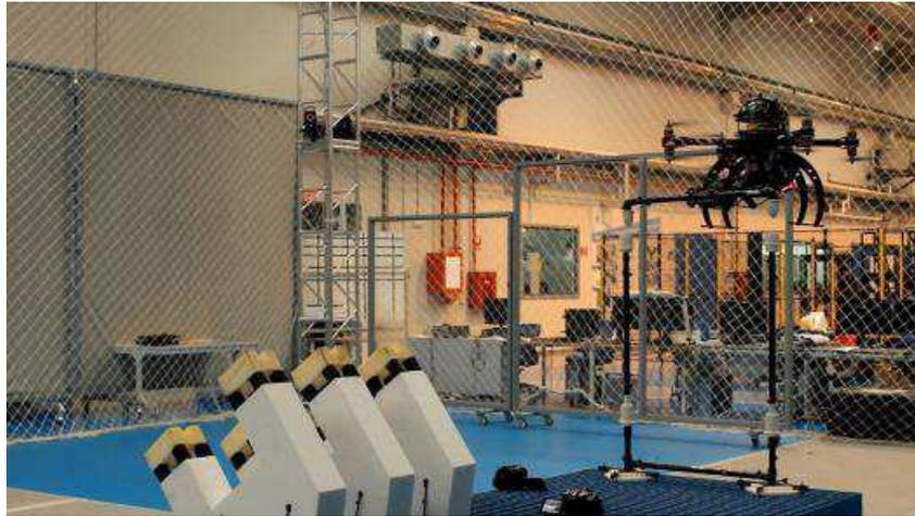
Fig. 26. Construcción autónoma con el prototipo 2 del manipulador aéreo de un pórtico con dos barras verticales y una barra horizontal
