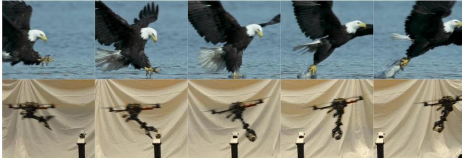
Fig. 15. Comparativa entre la forma de atrapar presas de un águila y la captura de objetos por un quadrotor moviéndose a 3m/s
