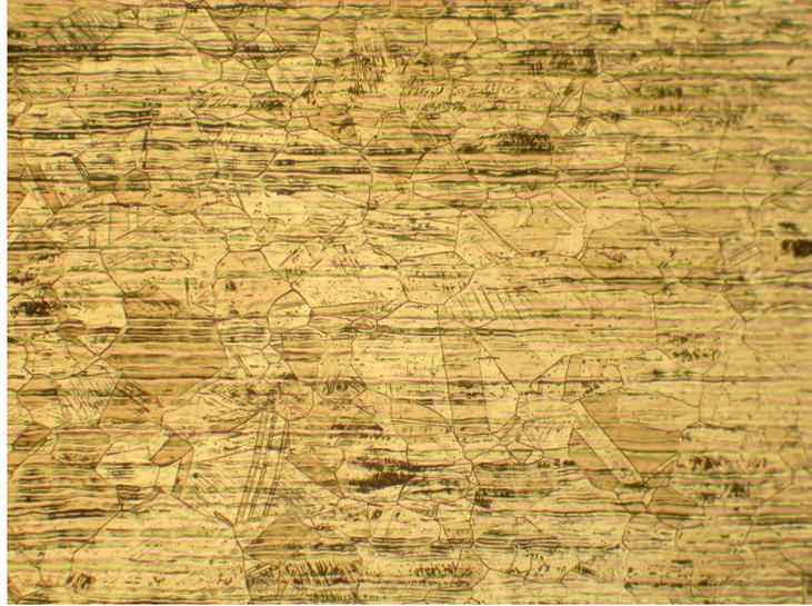
Figure 6.1: Microestructura del acero AISI 304L.
