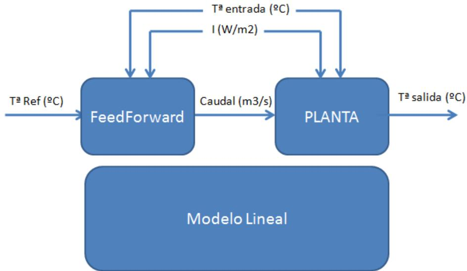
Figura 4.4: Equivalencia del modelo lineal con FeedForward+Planta.
