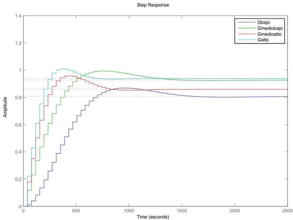
Figura 4.5: Respuesta ante escalón de los modelos lineales identificados.
