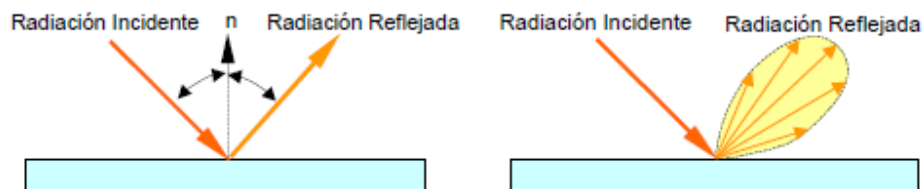
Figura 13. De izquierda a derecha, reflexión perfectamente especular y reflexión difusa (falta de especularidad)
