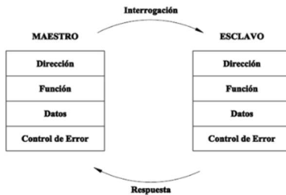
Figura A6.- Comunicación MODBUS
