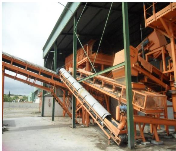
**Figura 7: Planta de Refino del Compost producido (Planta de Estepa).**
