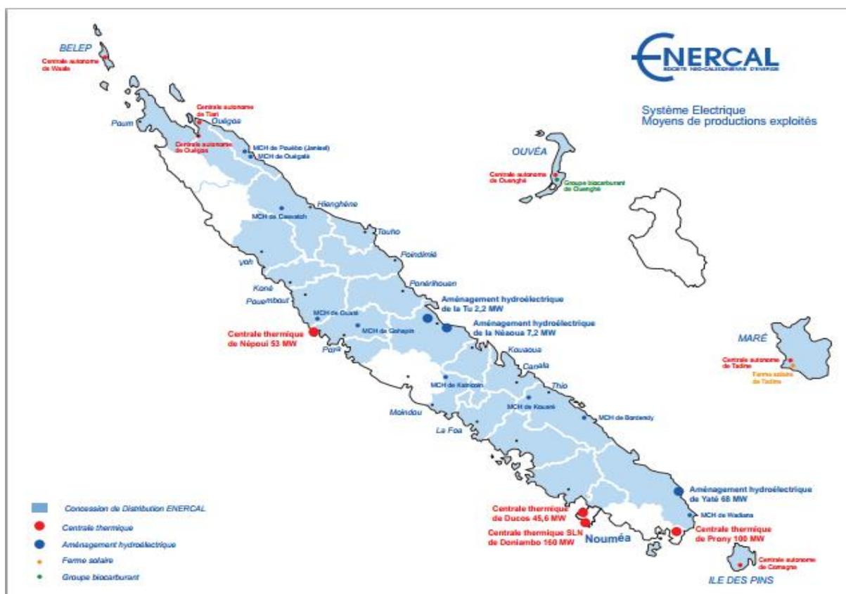
Ilustración 1.3: Medios de producción de energía eléctrica en Nueva Caledonia [8]
