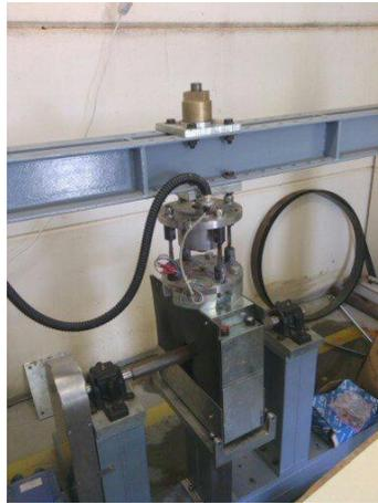
*Ilustración 1: banco de ensayos para fatiga por fretting existente.*
