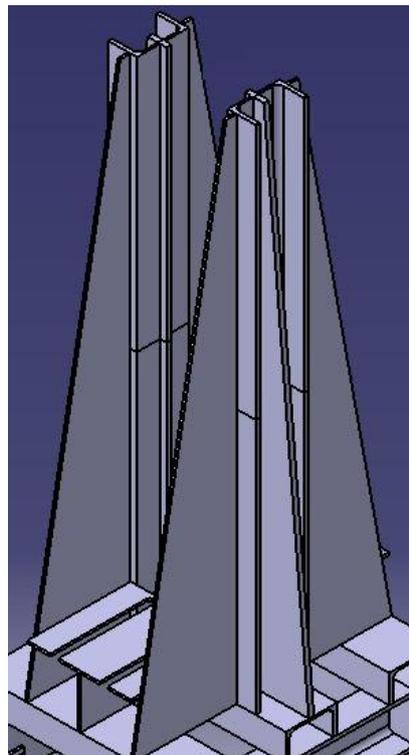
*Ilustración 36: montaje de las cuatro aletas longitudinales.*
