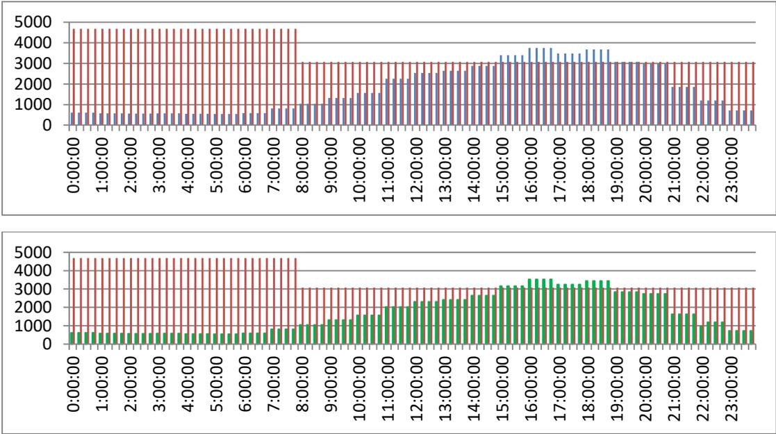
**Ilustración 9.- Diferencia entre los picos de potencia de un día completo sin uso (arriba) y con uso del sistema de sincronización de cargas (abajo)**
