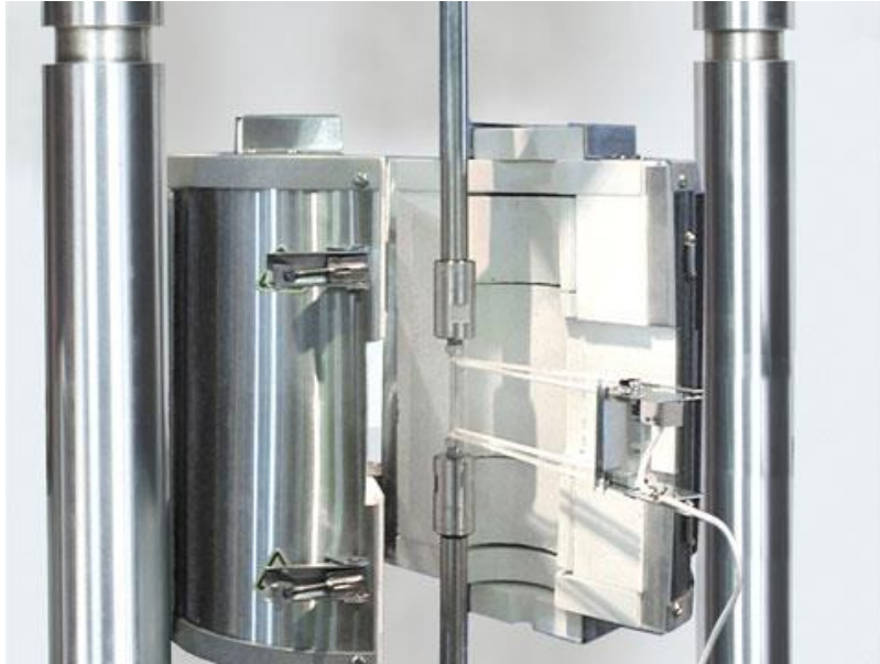
Figura 67 Modelo de horno, cogidas y extensómetro para ensayos mecánicos a alta temperatura
