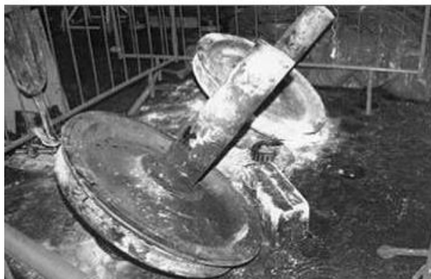
Figura 11. Eje fracturado del tren de mercancías involucrado por fatiga en 1996 en Rickerscote
