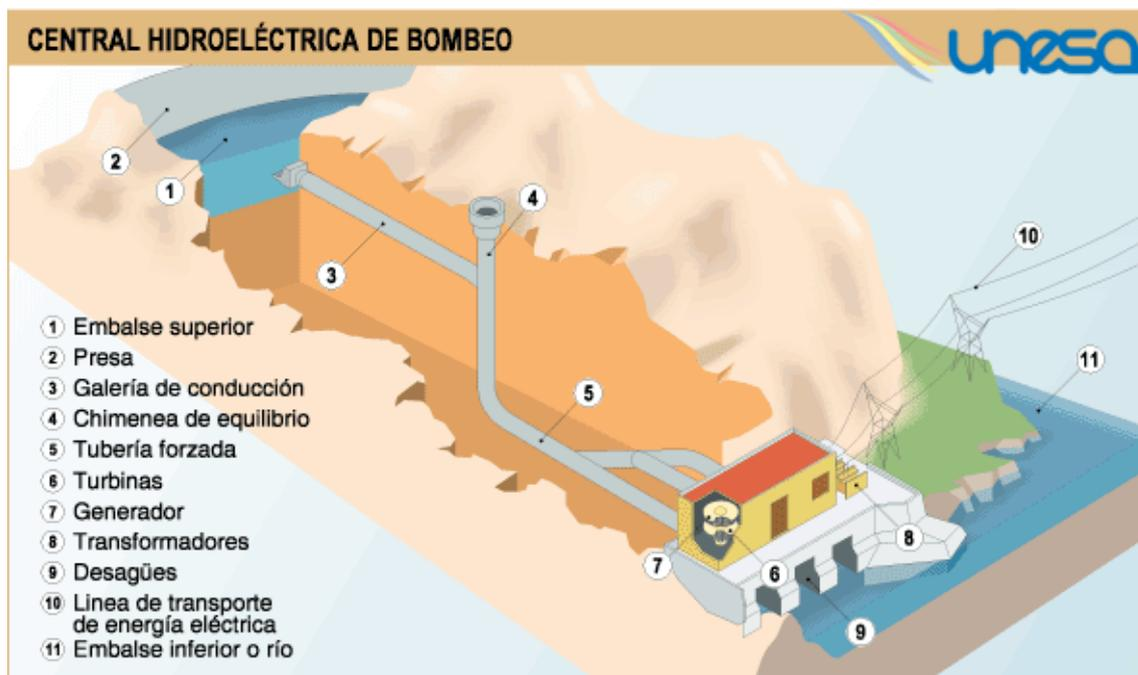
Figura 3-1. Esquema central hidroeléctrica de bombeo
