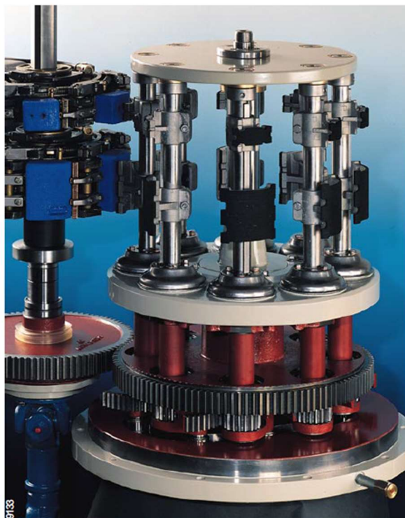
Figura 17. Carrusel de paletas y cilindro de transferencia
