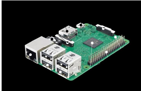
Figura 1-2. Raspberry Pi 3 modelo B.
