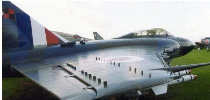
Figura 1.6: Generadores de vórtices sobre el ala de un Gloster Javelin (fotografía extraída de http://www.thunder-and-lightnings.co.uk )
