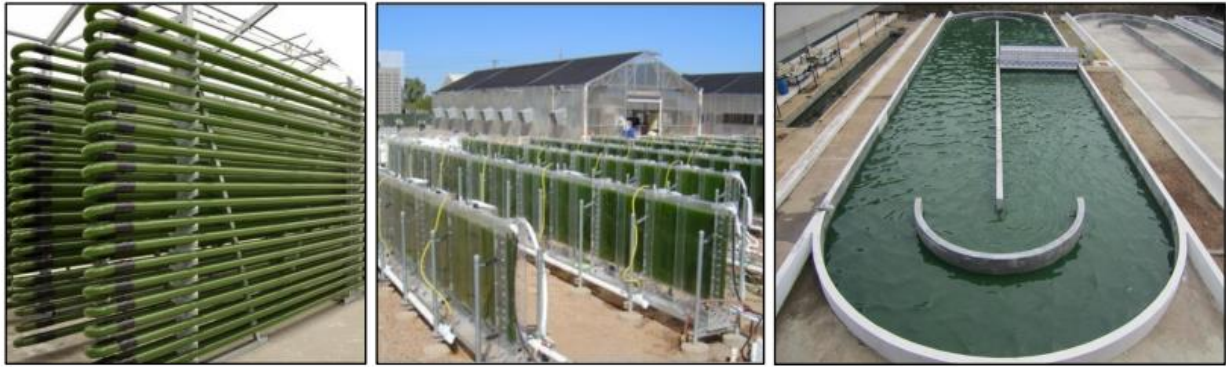
Figura 1.4: Ejemplos de fotobiorreactores tubular (izquierda), panel (medio) y cultivo abierto (derecha) (Salinas, 2016)
