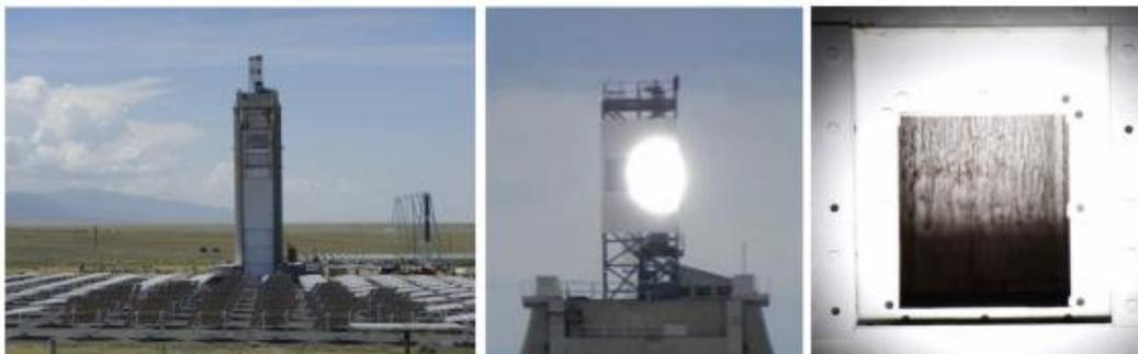
Figura 41. Prueba con sol de un receptor de partículas en el National Solar Thermal test Facility en Sandia National Laboratories, Albuquerque
