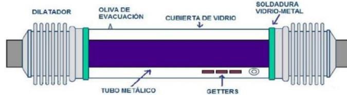
Figura 22. Esquema de un tubo receptor
