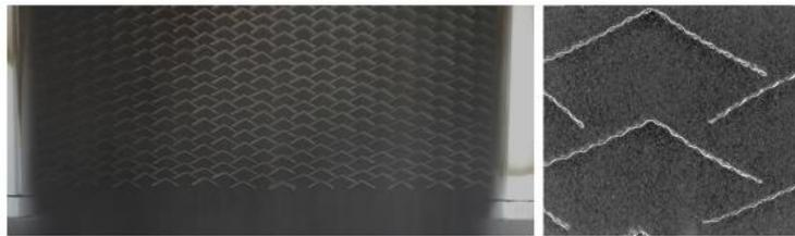
Figura 43. Imágenes de la malla de un receptor de partículas obstruido
