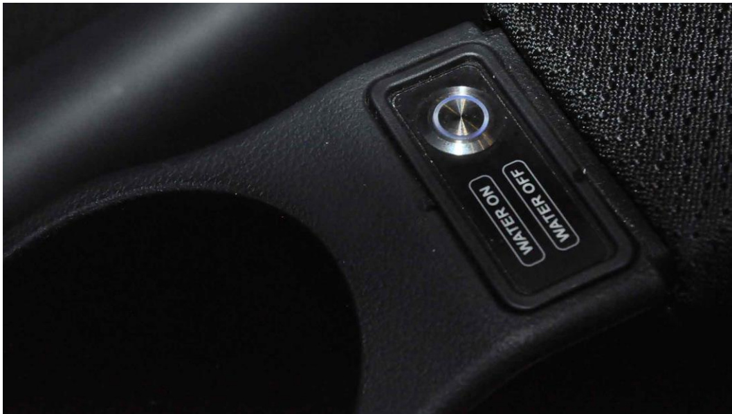
Ilustración 39: Se puede desactivar el agua en cada asiento
