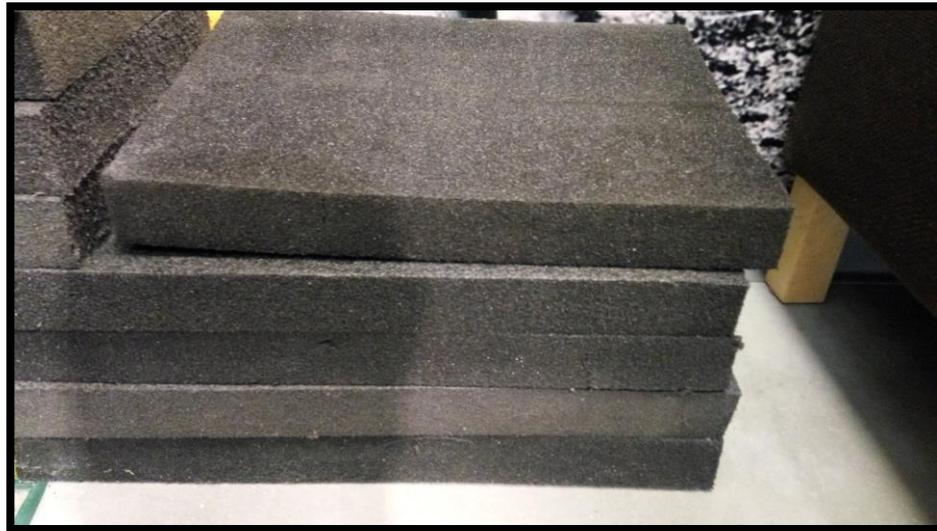
Una vez montada la primera parte de la estructura, se recortaron los corchos aislantes para adaptarlos a la separación que se quería crear y se colocaron las espumas de polietileno ya cortadas, en los tres espacios que había que taponar.
