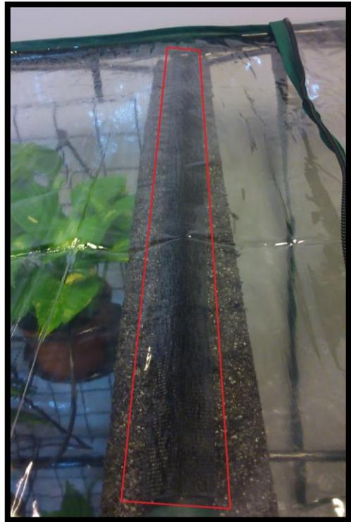
De esta manera, gracias a la utilización de la espuma de polietileno, la silicona y la cinta de velcro, se conseguía aislar los dos módulos para que sólo existiera la influencia de la vegetación en el compartimento donde se fueran a ubicar.
