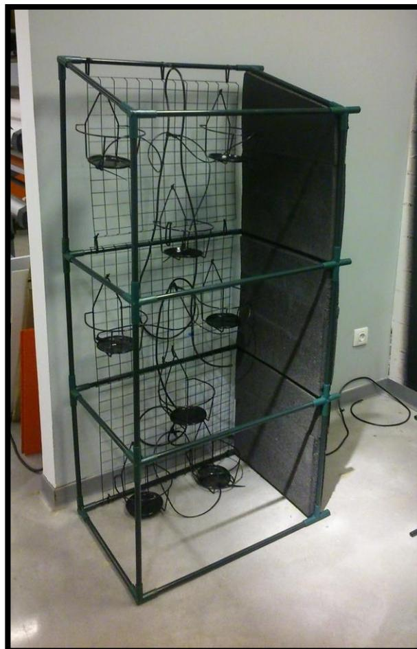
Para que no existiese ninguna influencia térmica ni ningún tipo de paso de agua entre un módulo y otro, se utilizó silicona para sellar la estructura de acero tanto al aislante al suelo.
