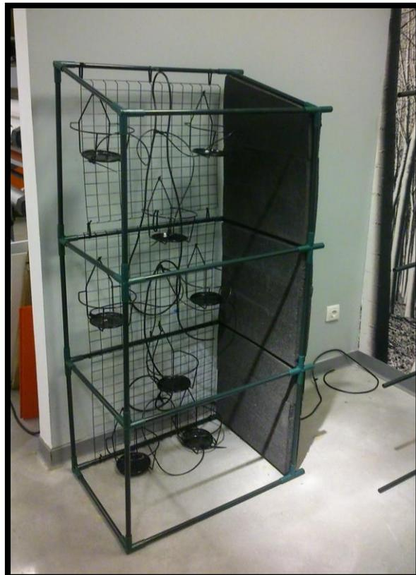
Por último, el agua que seguía circulando por la línea principal tras la última salida de riego, se conducía de nuevo al bidón de agua para que se recirculara (ya que no había sufrido contaminación alguna y así no existía un excedente de agua bombeada que causara problemas al experimento) y para que la reserva de agua para el riego requiriera menos mantenimiento.
