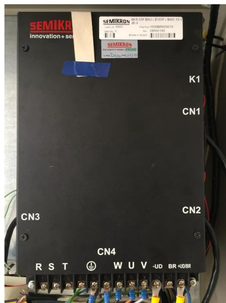
Figura 3. Convertidor de tensión SKS-22F B6u+E1CIF+B6CI 13 V12
