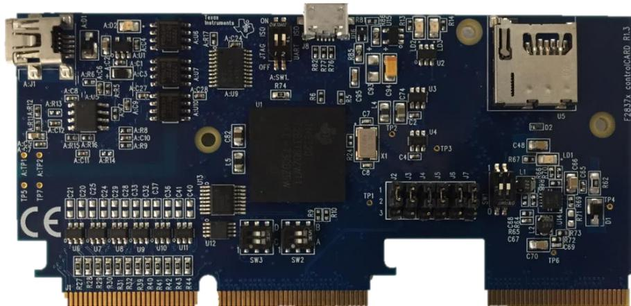
Figura 19. F2837x ControlCard R1.3 con DSP TMS320F28379D
