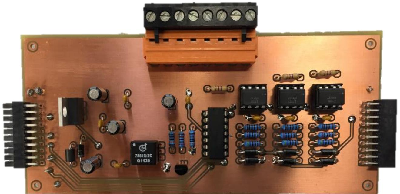
Figura 44. Vista superior placa de adaptación del Encoder
