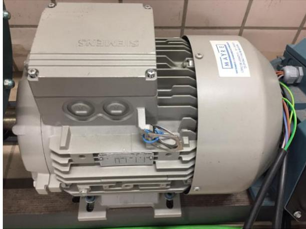
Figura 24. Máquina multifásica de 7 fases
