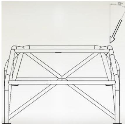
Figura 13. En vista frontal, inclinada 25° hacia el interior de la estructura
