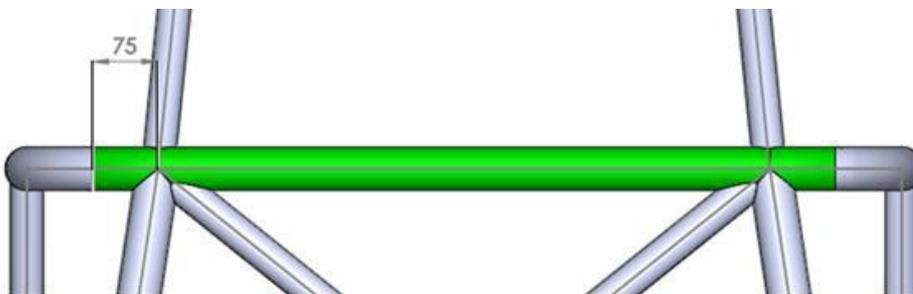
Figura 11. Vista en planta de detalle del arco principal, cotas en mm.
