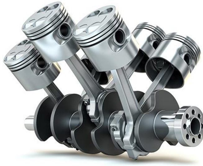
Figura 12. Configuración de cilindros en V. (Fuente: Los motores V6 porque se los llama así. < https://fierrosclasicos.com/ >.)
