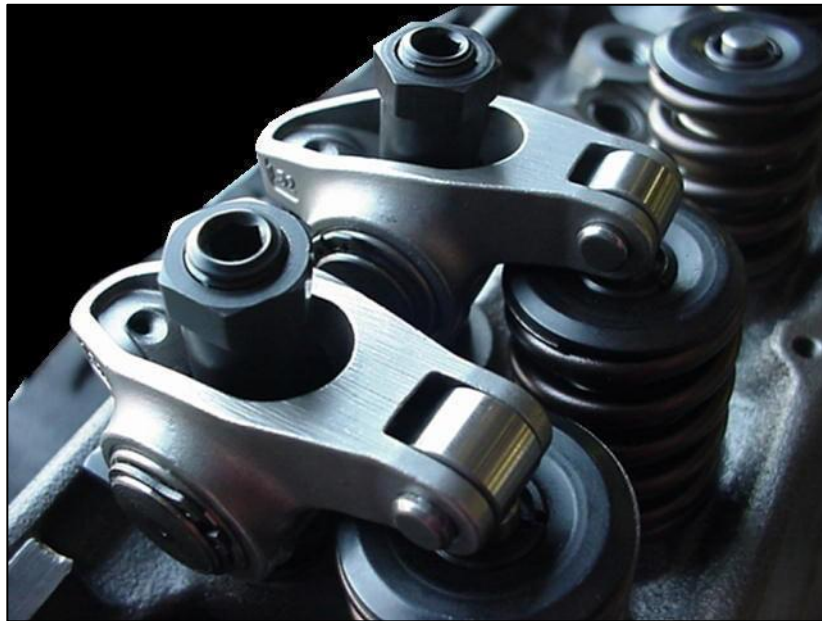
Figura 53. Disposición de los balancines sobre culata de un motor. (Fuente: Bolig, Randy. 2016. Can you gain horsepower by changing rocker arms? < www.chevyhardcore.com >.)
