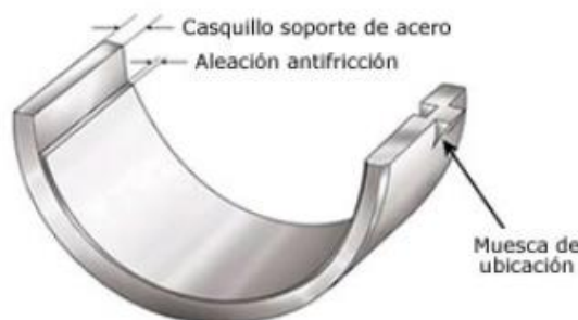
Figura 47. Partes de un semicojinete de bancada. (Fuente: Elementos móviles del motor . < http://www.aficionadosalamecanica.net/ >.)
