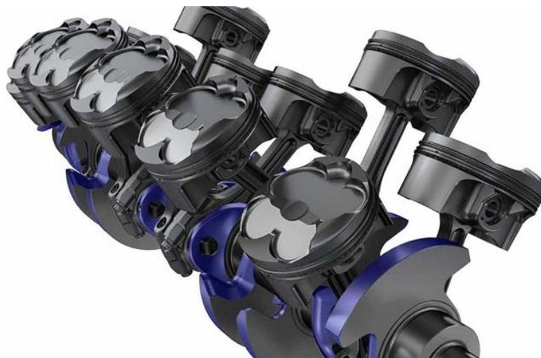
Figura 13. Configuración de cilindros en W. (Fuente: Análisis Técnico: Ferrari LaFerrari cigüeñal , 2013. < http://uvedoce.com/ >.)
