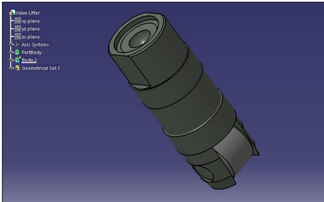
Figura 109. Imagen del diseño en CATIA del elevador de válvula hidráulico.
