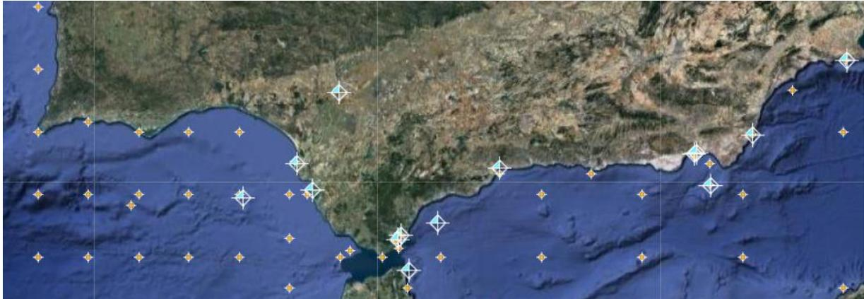
Figura 2-10. Red de medida de viento de Puertos del Estado
