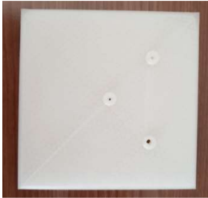
Ilustración 58. Pieza de soporte inferior con fallo de fabricación.
