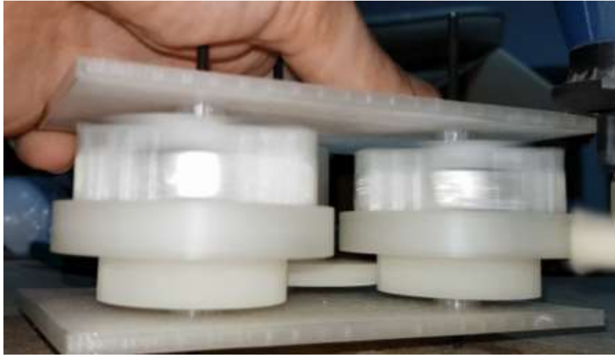
Ilustración 68. V.I.M. rotor-rotor con 4 imanes en rotación, accionado por minitaladro.
