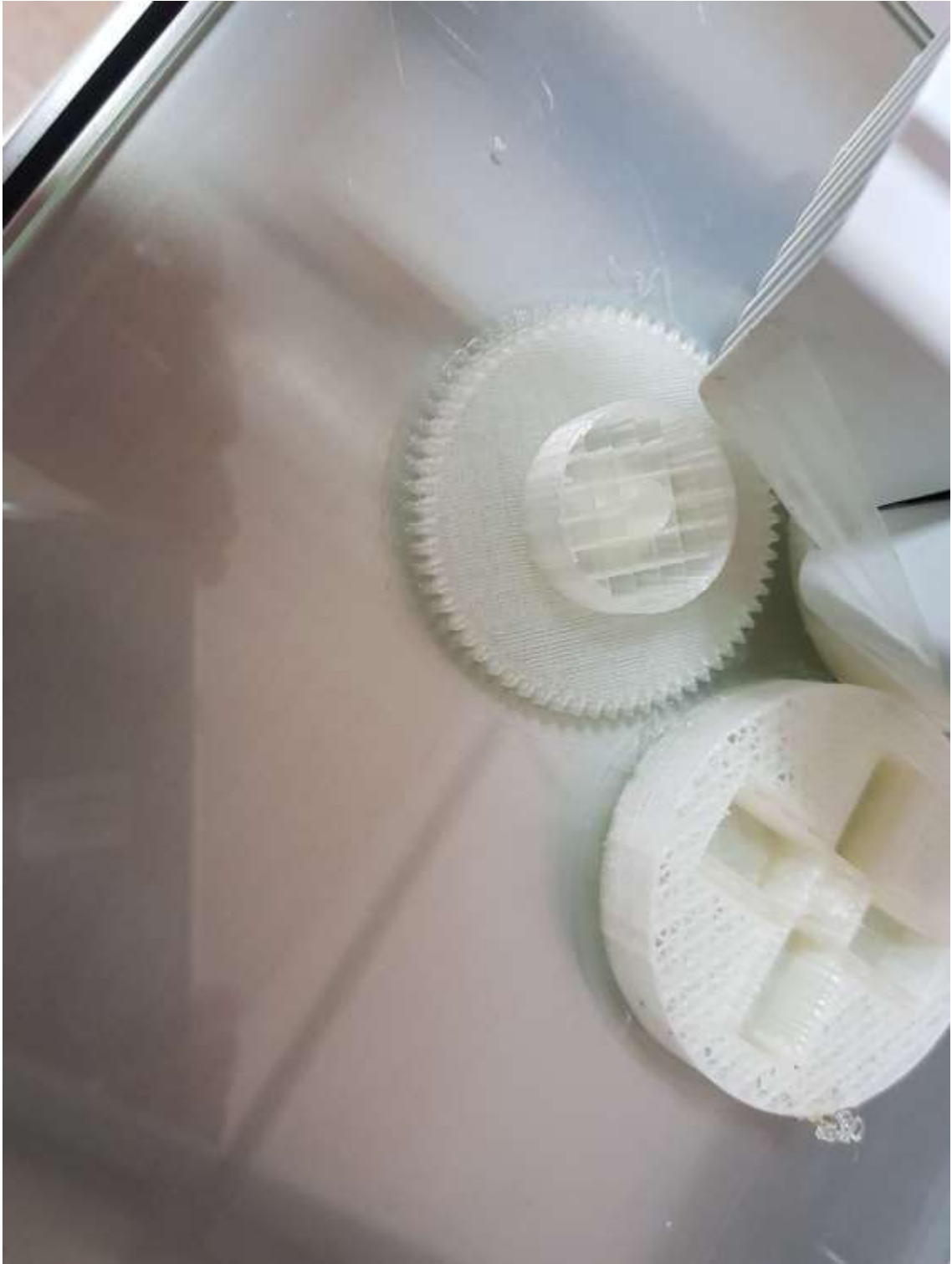
Ilustración 52. Proceso de fabricación de rotores y enlace mecánico. Al 35% de la fabricación. Las piezas una vez terminadas se retiran de la impresora y se les quita el material de soporte.
