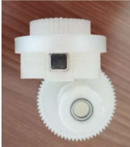
Ilustración 55. Pieza rotor y accinadora con imán y rodamiento montado.
