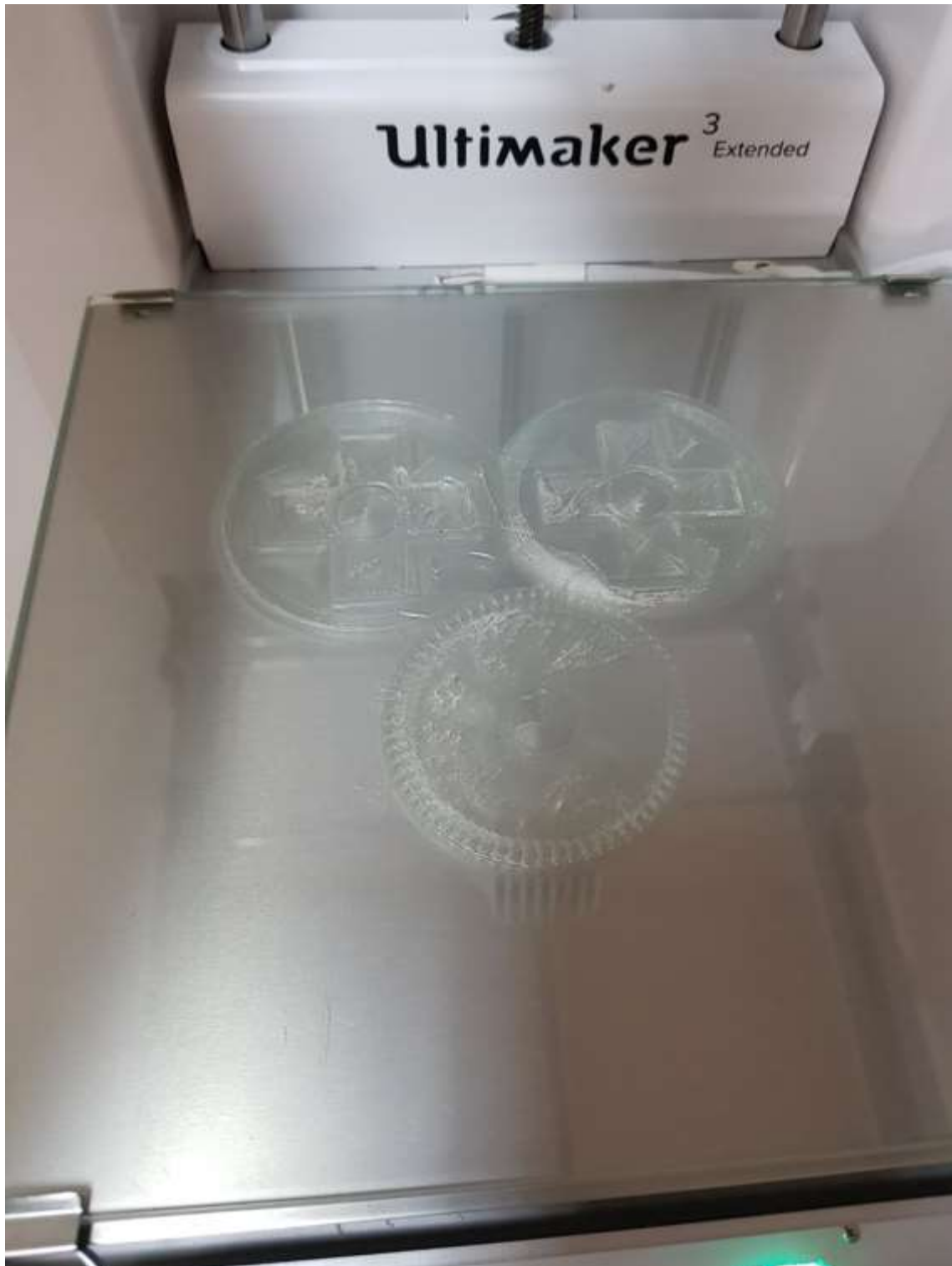
Ilustración 50. Proceso de fabricación de rotores y enlace mecánico. Capa de soporte y adhesión.
