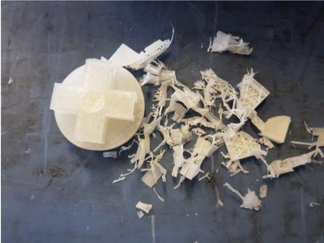
Ilustración 53. Pieza de rotor terminada con el material de soporte retirado.
