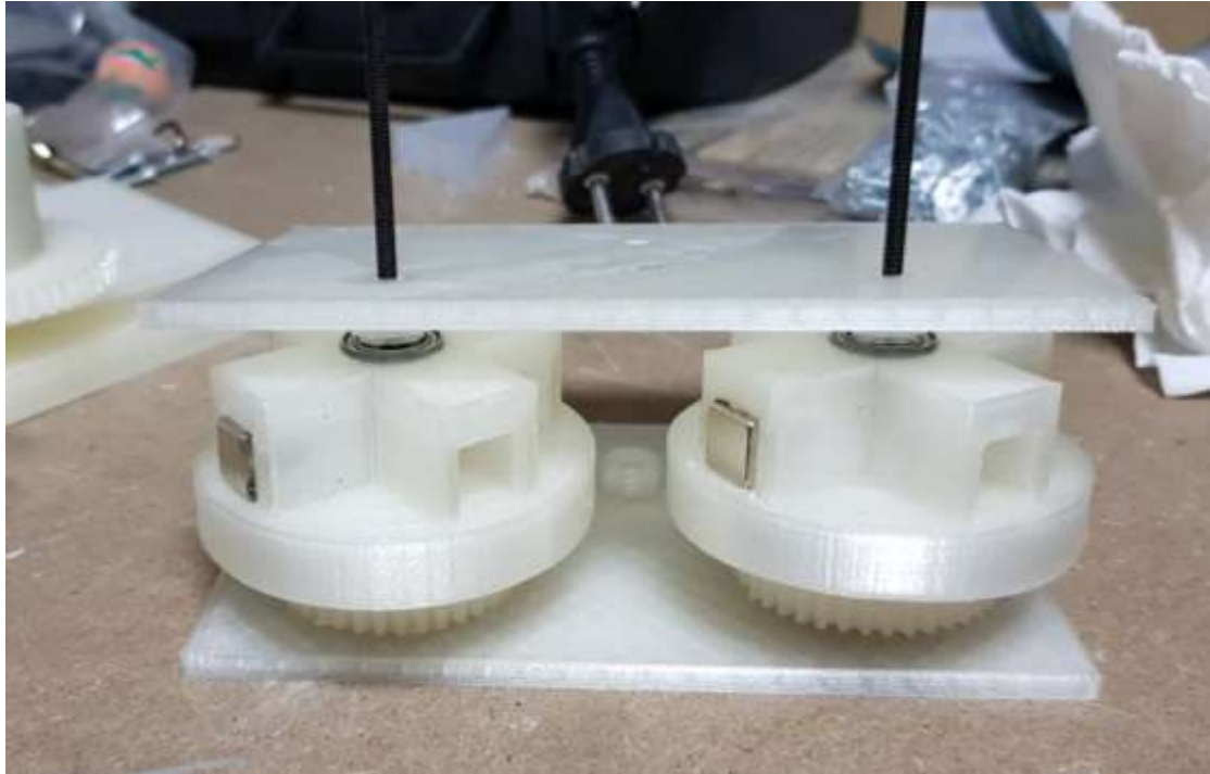
Ilustración 56. Ensamblaje del V.I.M. con enlace magnético.
