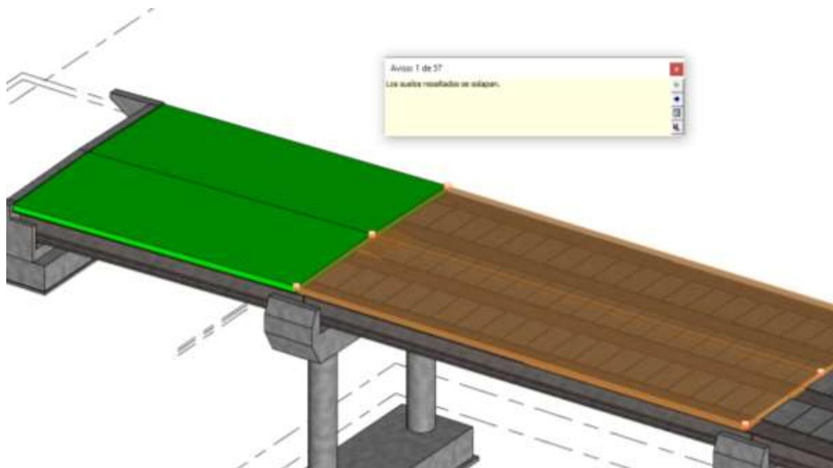
*Ilustración 8.28 Avisos de Revit® durante la fase de modelado. Fuente: El. prop.*
