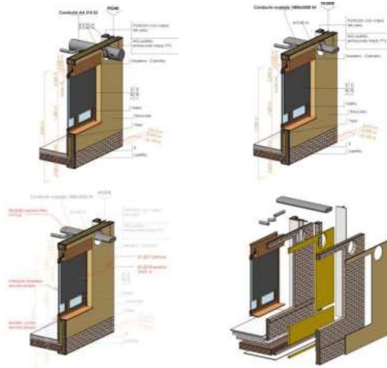
Ilustración 1.9 Niveles de Detalle G-350 – G-600 de un elemento BIM. Fuente: *esbim.es* [14]
