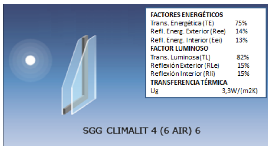
Figura 55. Doble Acristalamiento Climalit 4+6+6
