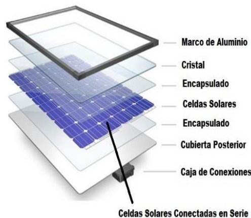
Figura 4. Composición de módulos fotovoltaicos [10]
