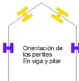
Figura 22. Orientación de perfiles en viga y pilar
