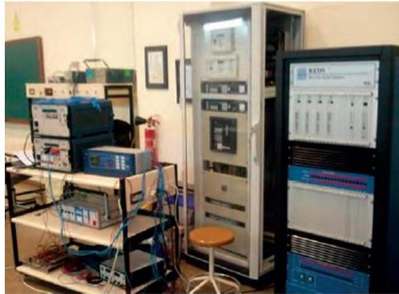
Ilustración 59 Fotografía de los equipos que conforman el RTDS de la microrred del GIPSE. [65]
