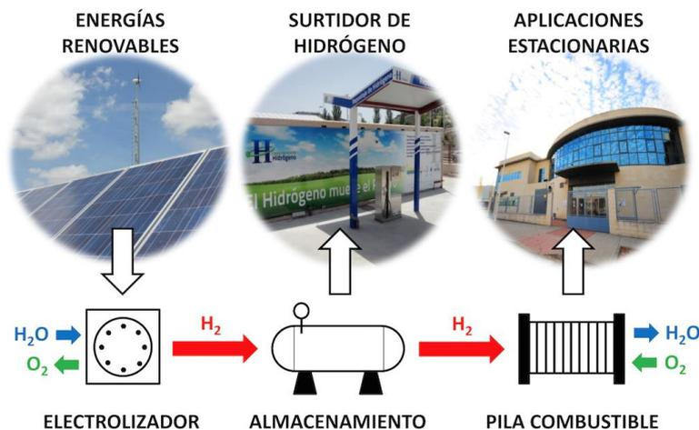
Ilustración 29 Esquema de sistema de almacenamiento de energía en forma de hidrógeno [21]
