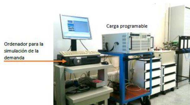
Ilustración 45 Carga programable junto a ordenador de simulación de demanda doméstica. (UPNA).[29]
