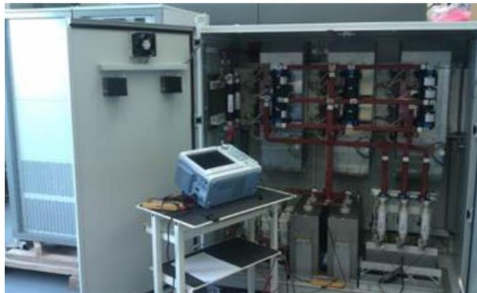
Ilustración 85 Convertidor medio de energía de tensión : 4 kV junto a la fuente de corriente continua de 150 kW de la microrred de la Universidad de Oviedo [62]
