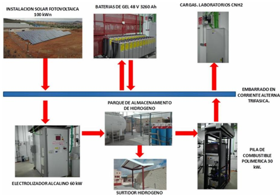
Ilustración 36 Esquema de la microrred del Centro Nacional de Hidrógeno [24]
