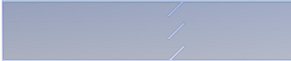
Figura 60. Vista en planta de las lamas con una orientación de 45°
