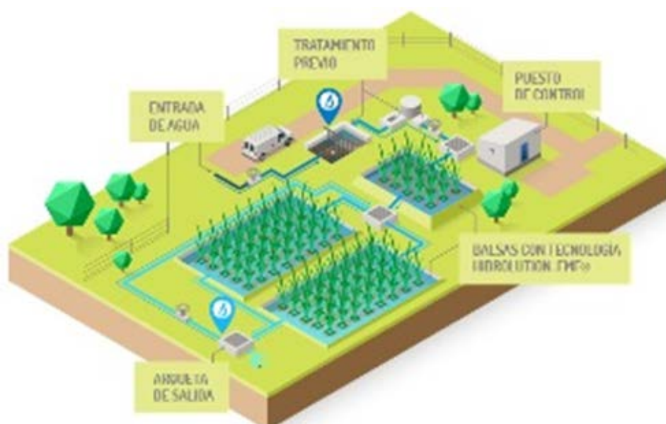
Figura 5-31. FILTRO DE MACROFITAS EN FLOTACIÓN HIDROLUTION FMF®. Fuente: https://www.aguasresiduales.info/revista/noticias/filtro-de-macrofitas-en-flotacion-hidrolution-fmf-la-depuracion-que-se-adapta-al-ento-Xczs3 .
