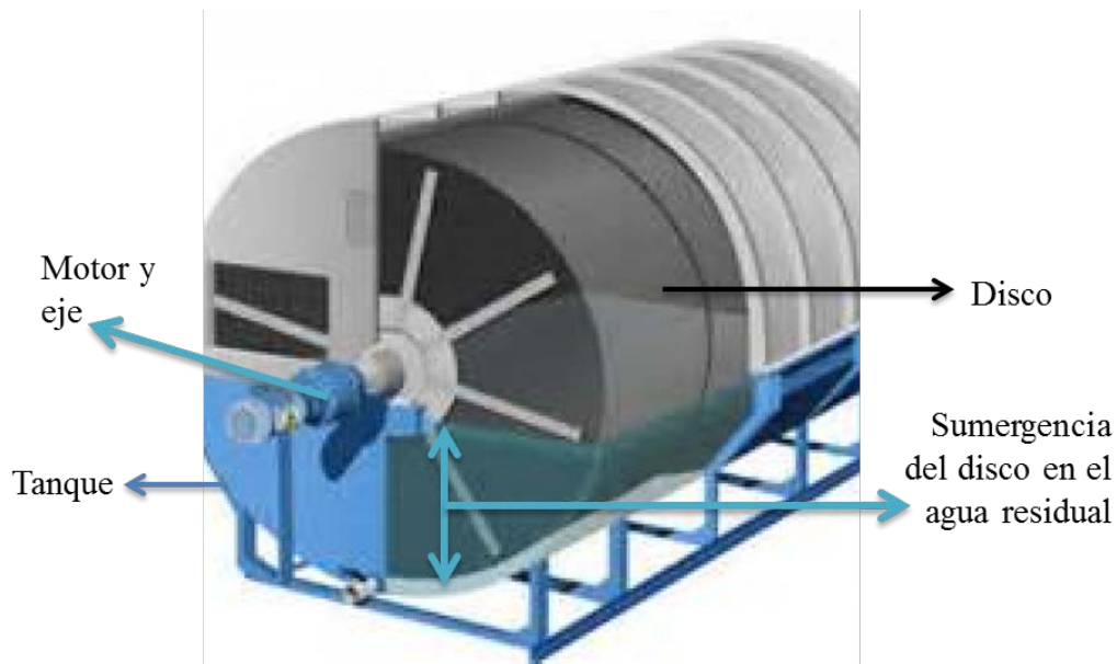
Figura 5-11. Biodisco Sencillo y sus Principales Partes. Fuente: editado de https://www.iagua.es/blogs/jorge-chamorro/depuracion-principiantes-ix-i-tratamiento-imhoff-biodiscos .
