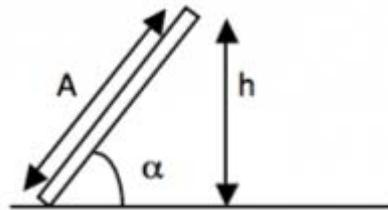
Figura 5.13.- Dimensiones de un panel fotovoltaico [20]
