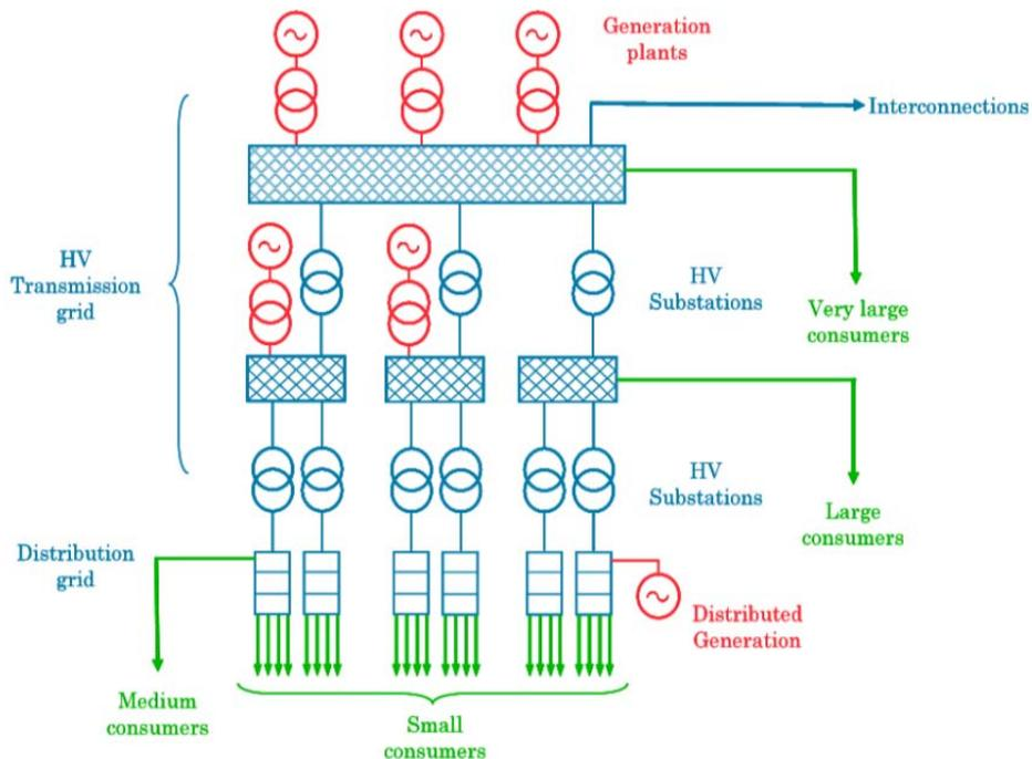
Figura 3.9. Esquema de un sistema de Generación Distribuida [3].
