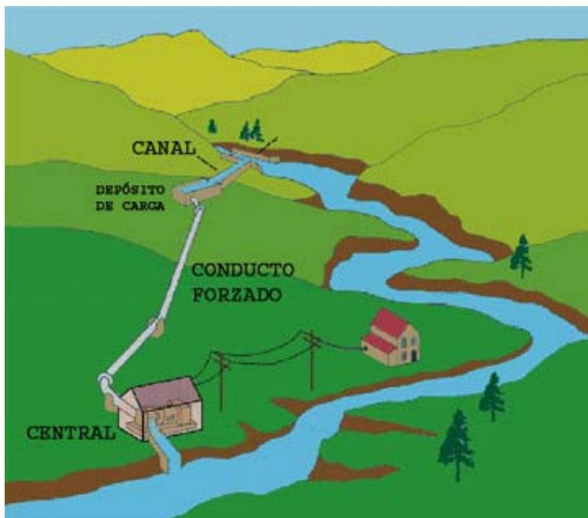
Figura 3.11. Esquema de una central hidráulica de agua fluyente [9].
