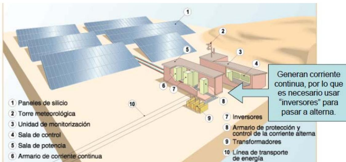
Figura 3.18. Esquema de un parque fotovoltaico [8].
