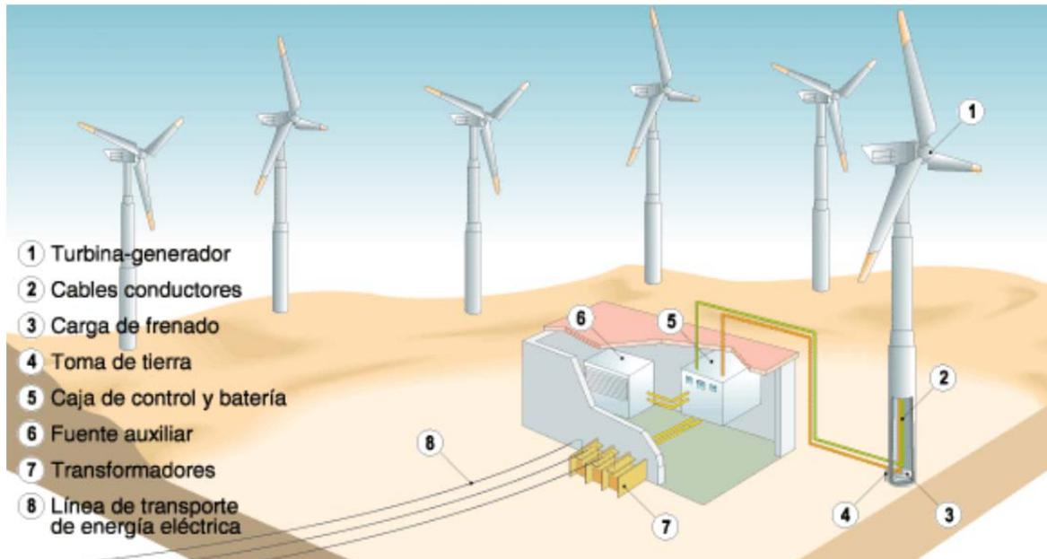
Figura 3.14. Esquema de un parque eólico [8].
