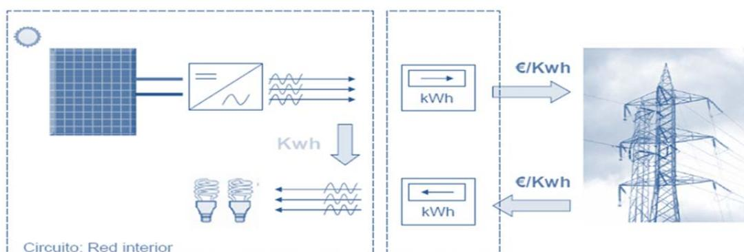
Figura 5.1.- Esquema Central Solar Fotovoltaica para Autoconsumo [19]
